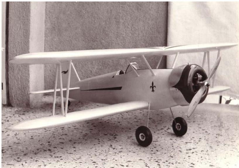
Il bellissimo PT 17 semiscala acrobatico di Leone Parlavecchio. Il modello aveva un'apertura alare di 130cm ed i flaps nell'ala inferiore. Con un ST60, elica 13/6 ed un peso di 1700 grammi aveva eccellenti doti di volo acrobatico. La carenatura motore era in alluminio lucidato, verniciata in parte in rosso brillante. Palermo 1975.
