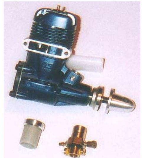
**L'OS46LA rimontato con le modifiche citate nel testo. In evidenza il venturi in ottone con lo spruzzatore saldato, il filtro dell'aria e l'ogiva in alluminio.**
