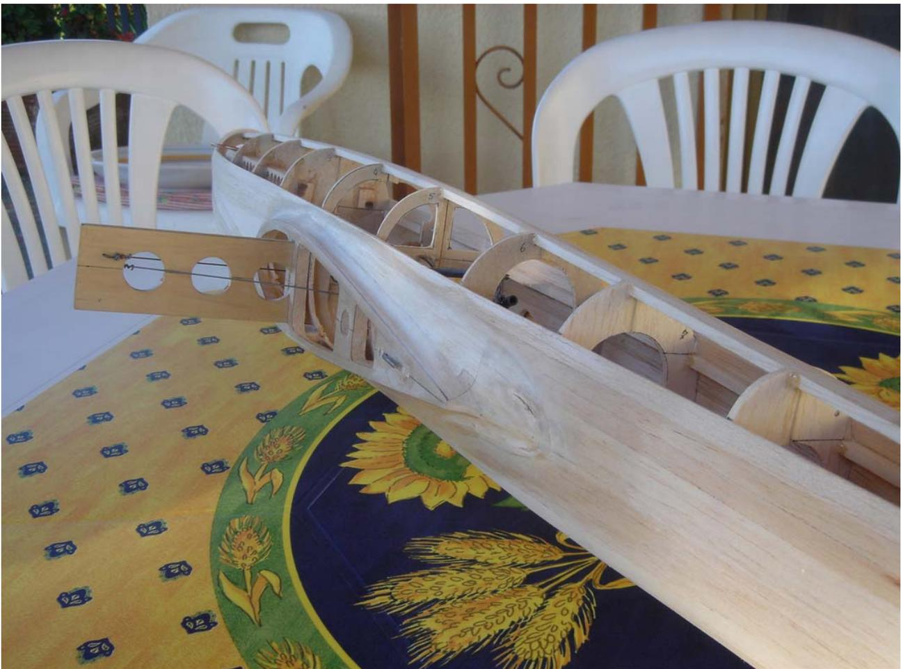
**Questa vista da  $\frac{3}{4}$  posteriore della fusoliera di Ennio Marra ci permette di apprezzare l'elegante linea filante della fusoliera. Da sottolineare i pregevoli raccordi aerodinamici tipo *Karman* tra la sezione di attacco dell'ala e la fusoliera.**
