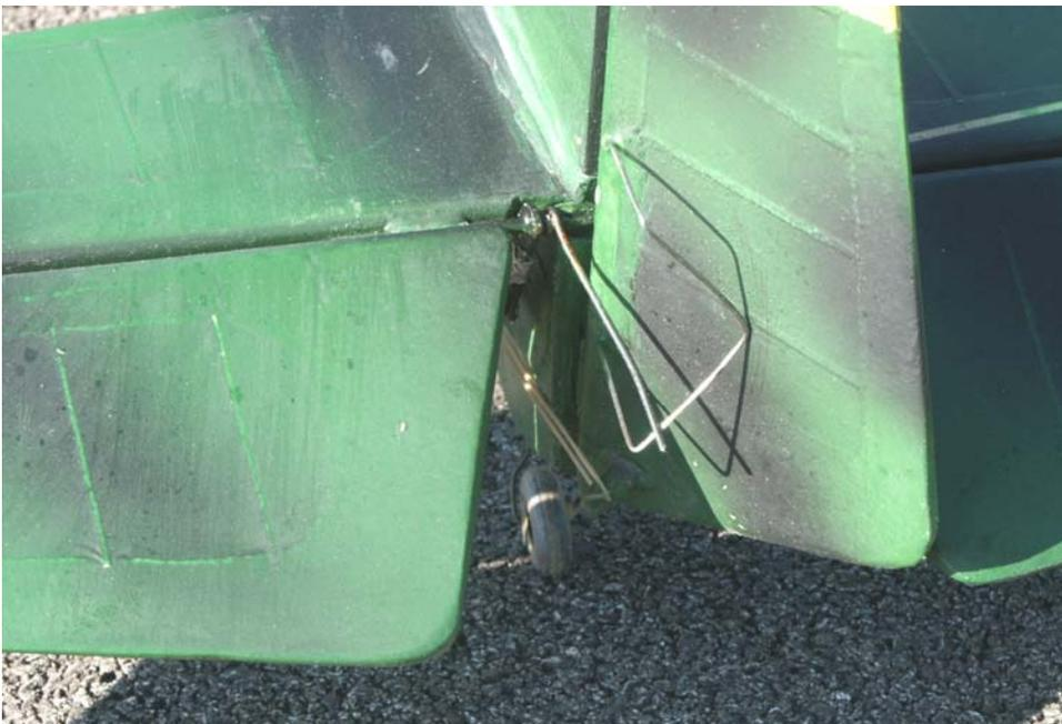
**Il direzionale mobile di Lucio Raccuia di Reggio Calabria. Al direzionale è fissata la "V" in acciaio mentre alla squadretta di comando dell'elevatore è saldata una barra da 2mm di acciaio che, alzandosi e abbassandosi con l'elevatore, scorre sulla "V" spingendo verso l'esterno la deriva. Modificando l'angolo della "V" è possibile regolare l'escursione del direzionale in modo differenziato per la cabrata e la picchiata, fino a farlo muovere solo con il comando a picchiare.**
