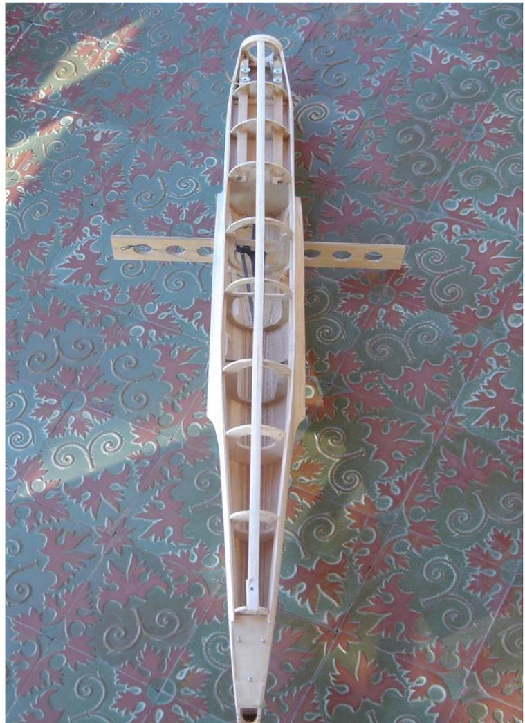
**Una vista dall'alto della fusoliera durante la fase di costruzione. Il modello sarà completamente smontabile: semiali, piani di coda, deriva. In questo modo sarà possibile accedere alle squadrette ed ai rinvi per una completa possibilità di regolazione.**
