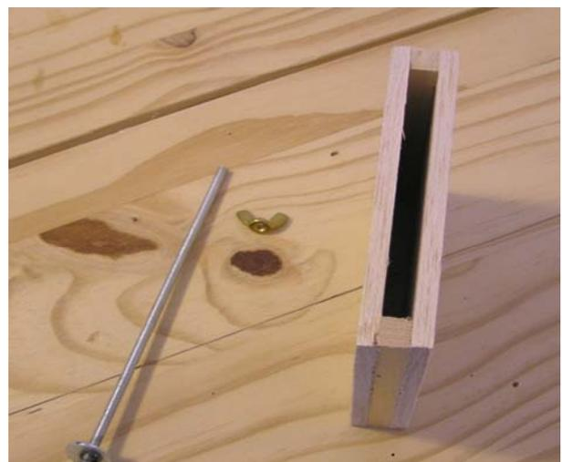
Un parallelepipedo in balsa con la barra filettata e dado a farfalla.
