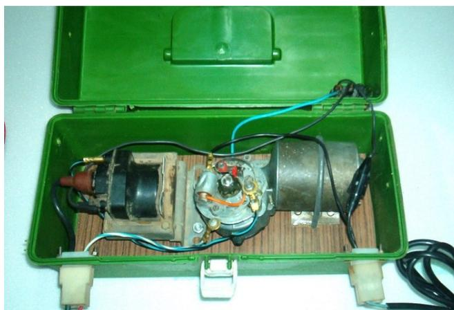
**Il “vibratore” (con relativa “supposta”) necessario per l’avviamento di un pulsogetto (foto Scotto Di Marco)**
