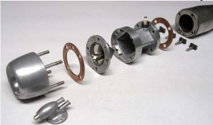
Il Minijet smontato. A differenza del Dynajet, tutti i pezzi sono ricavati per fusione
