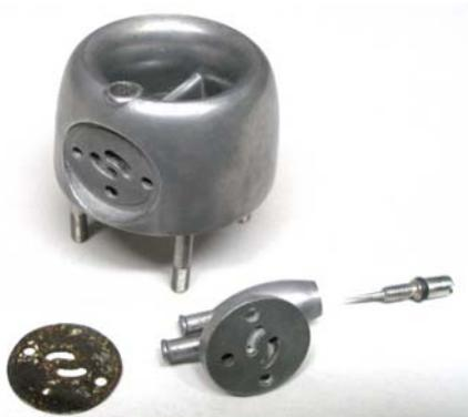
La testata con il carburatore. Il condotto prossimale è in comunicazione con la camera di scoppio e consente la pressurizzazione del serbatoio.
