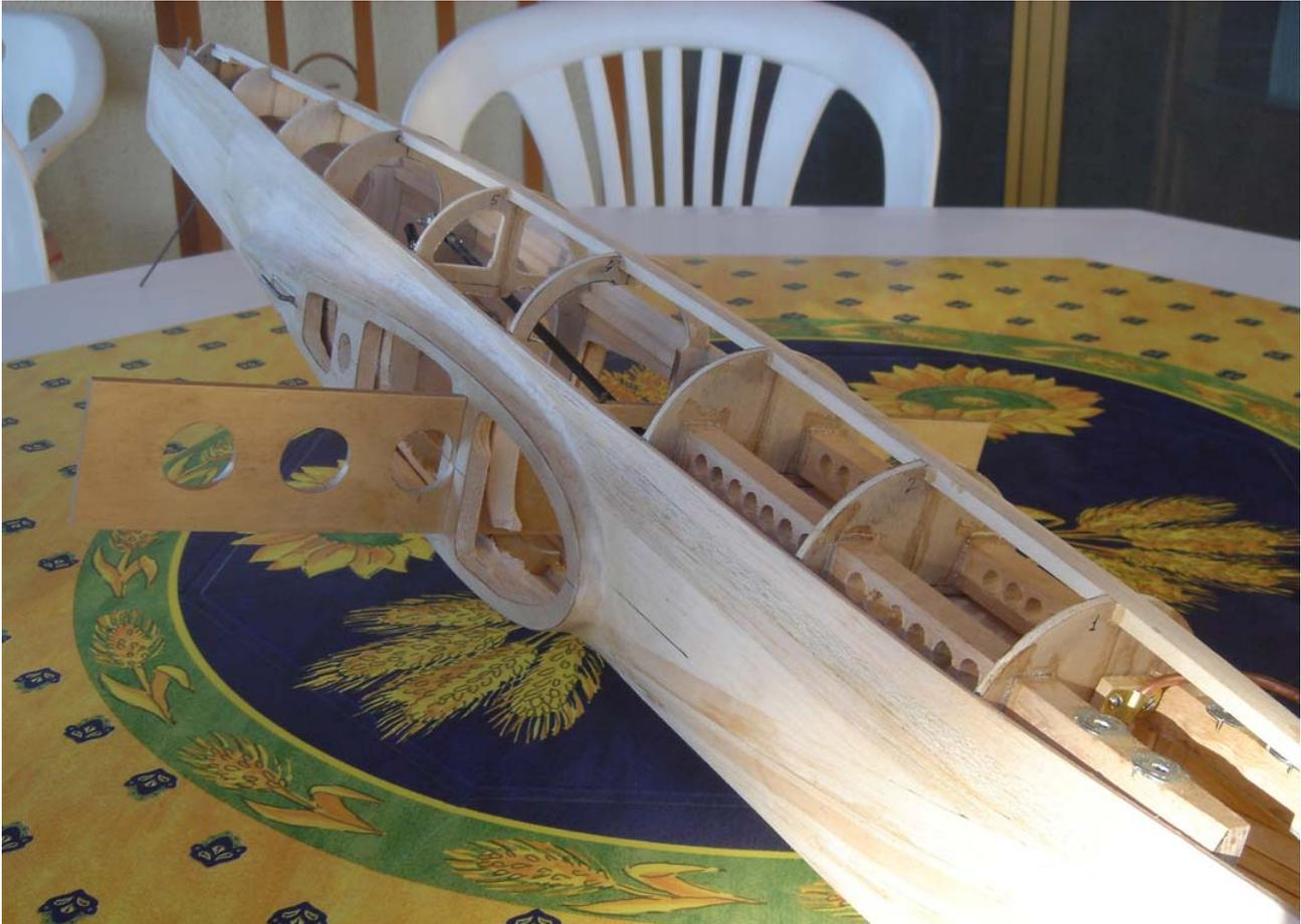
**Vista  $\frac{3}{4}$  anteriore. In evidenza il castello motore con le longherine alleggerite e la totale assenza di ulteriori rinforzi. Questi ultimi non sono necessari grazie alla struttura a sezione ellittica che garantisce una notevole rigidità e robustezza.**
