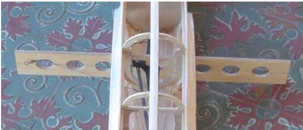
**Particolare della squadretta in fibra di carbonio in posizione invertita. I comandi del modello, il sistema di fissaggio delle semiali e dei piani di coda con le relative squadrette, saranno oggetto di un approfondimento nel prossimo articolo.**
