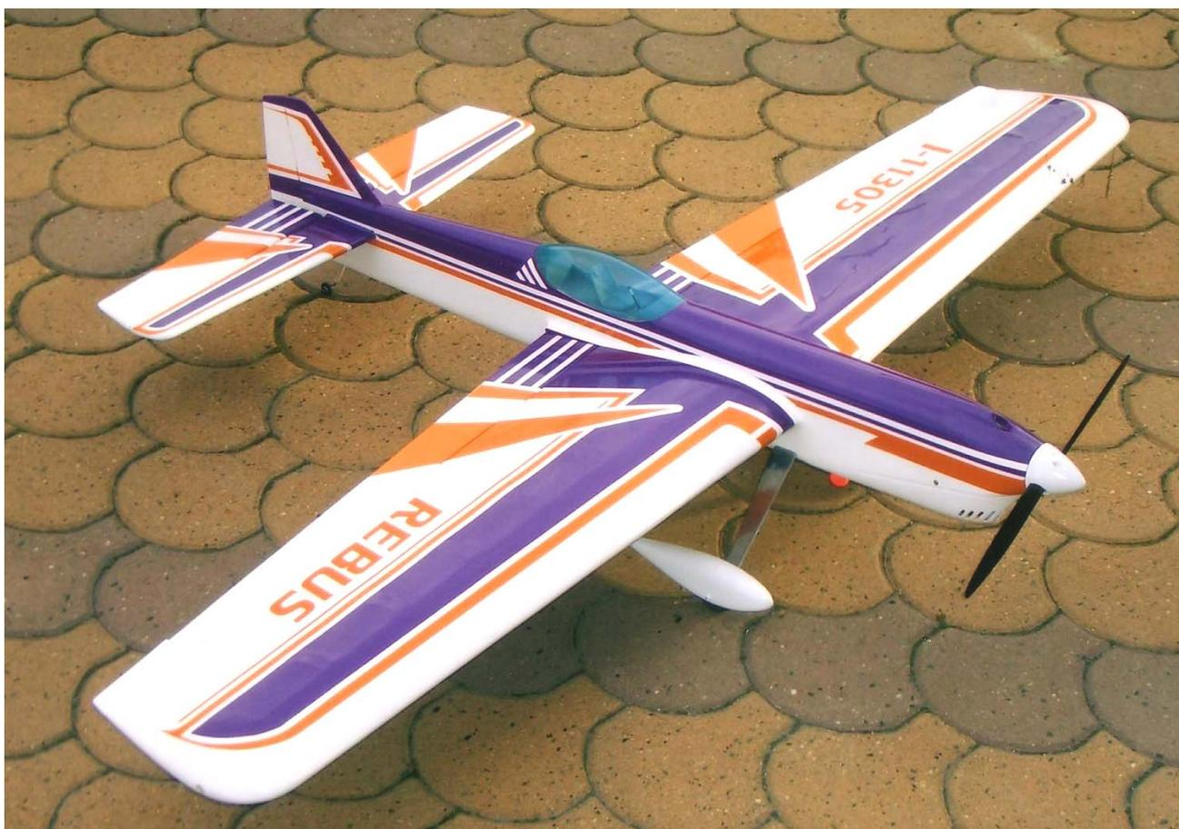
Il modello, a questo punto, è finito. Si montano motore, serbatoio ed elica e si passa alle prove di volo. Fin dalle prime prove ho capito che il *REBUS* aveva buone doti di volo. Nonostante i suoi 1940gr era affidabile e sicuro. Anche grazie allo *STALKER 61 RE 2-2* che ho potuto constatare essere un ottimo motore per potenza e regolarità.
