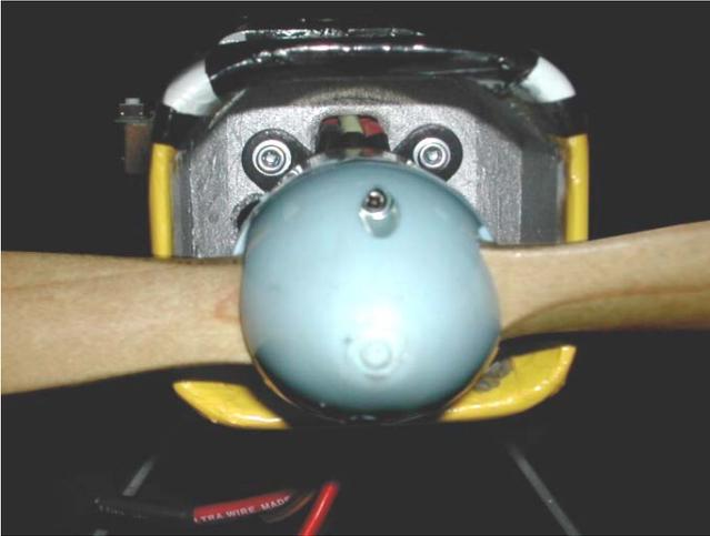
La parte anteriore del muso è completamente aperta per favorire l'entrata dell'aria per il raffreddamento; il motore è montato posteriormente sull'ordinata parafiamma, dotata di fori che consentono il raffreddamento anche del vano batteria.
