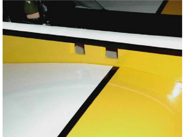
Sulla fusoliera, dietro il vano batterie, due aperture per lato permettono la fuoriuscita dell'aria calda.
