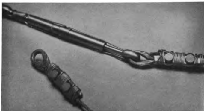
Abb. 24. Sichern eines Spannschlusses und die Verwendung einer Seilklemme.
