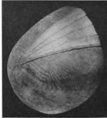
Abb. 73. Verleimen einer Rumpfnase auf einem Vollholzklotz.
