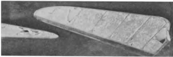
Ab. 10. Durch Hagelschlag zerstörte Höhenruderbespannung.
