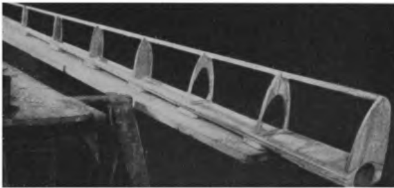
Abb. 139. Höhenruderholm mit aufgesetzter Rippennase und Sperrholzrohr.
