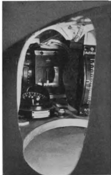
Abb. 135. Instrumenteneinbau beim Fafnir (durch die Führerluke gesehen).
