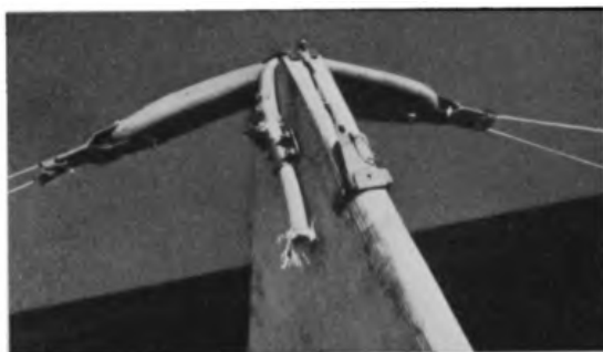
Abb. 146. Zögling mit Federung für die oberen Abfangdrähte.
