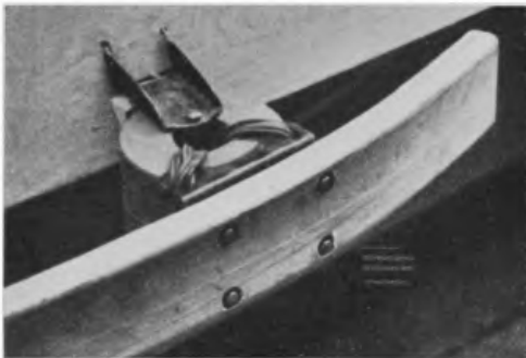
Abb. 120. Befestigung eines runden Gummiklotzes.
