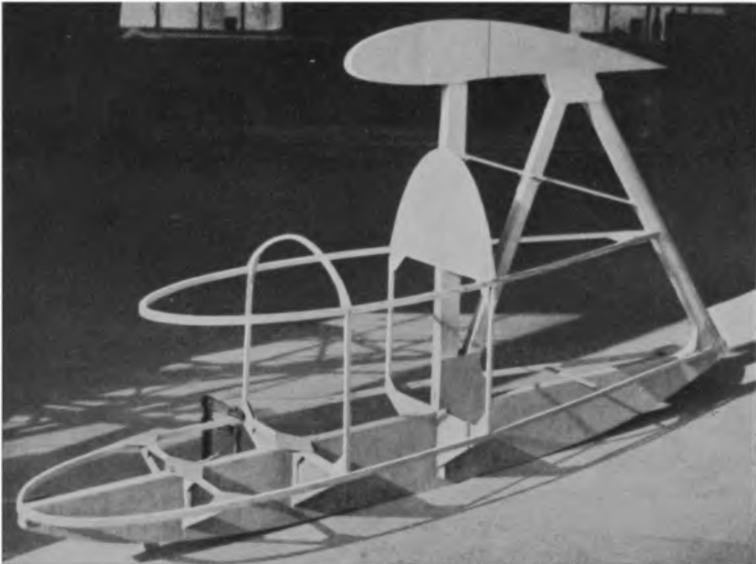
Abb. 111. Spante am Spannturm 3 .
