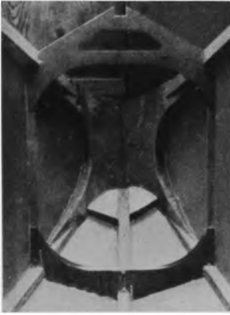
Abb. 71. Rumpfnase aus Sperrholz verleimt.
