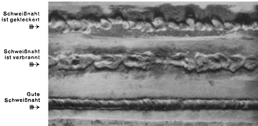
Abb. 21. Schweißnähte.
