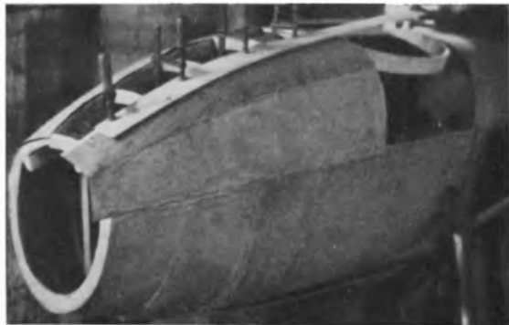
Abb. 130. Sperrholz wurde teilweise aufgezo-
