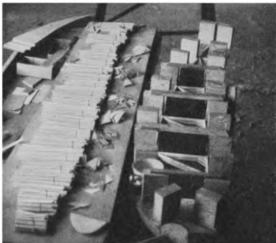
Abb. 51. Rippenkasten mit vorgerichteten Ecken u. Leisten.
