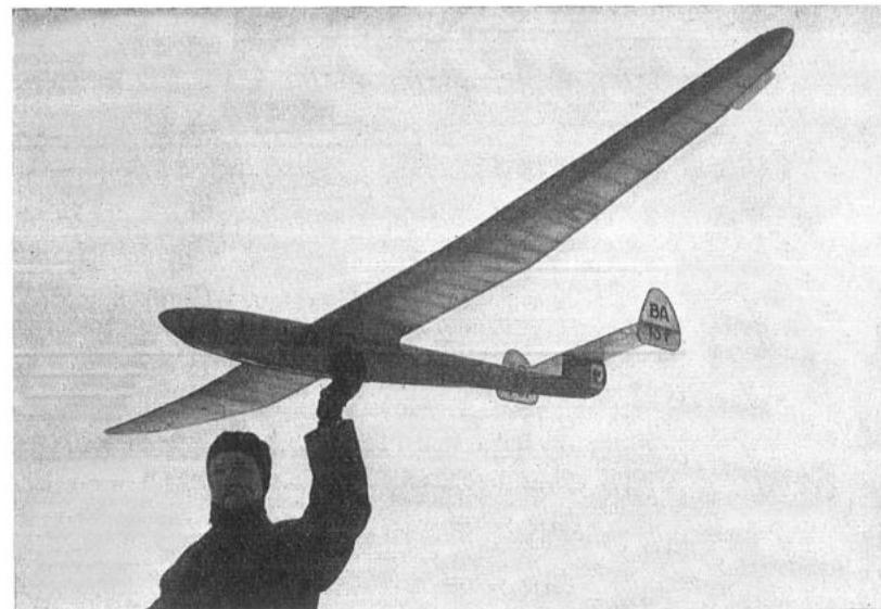
Fig. 134. Aeromodello da competizione con fusoliera in compensato e timone di direzione doppio. Costruzione di J. Devaud, Basilea.
