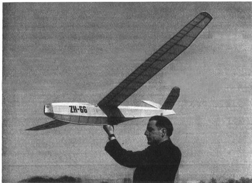
Fig. 81. Aeromodello da competizione «Wulp» con impenaggio orizzontale a V, costruito da E. Glünkin.
