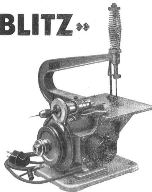
che permette di ottenere nel legno un taglio netto senza sbavature, nello spessore fino a 30 mm. Taglia pure lamiera di ferro, alluminio, ottone ecc. Viene azionata da un eccellente motore 1/12 HP 900 giri. Peso ca. kg. 18.
