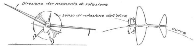
Fig. 12. Effetto del momento dell'elica in un aeromodello a propulsore.
