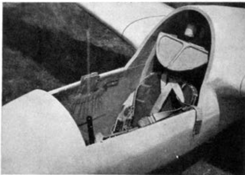
Fig. 148 bis. - Abitacolo del pilota del « Papero ». Si nota il barografo situato dietro il poggiatesta. (Foto M. Galimberti).
