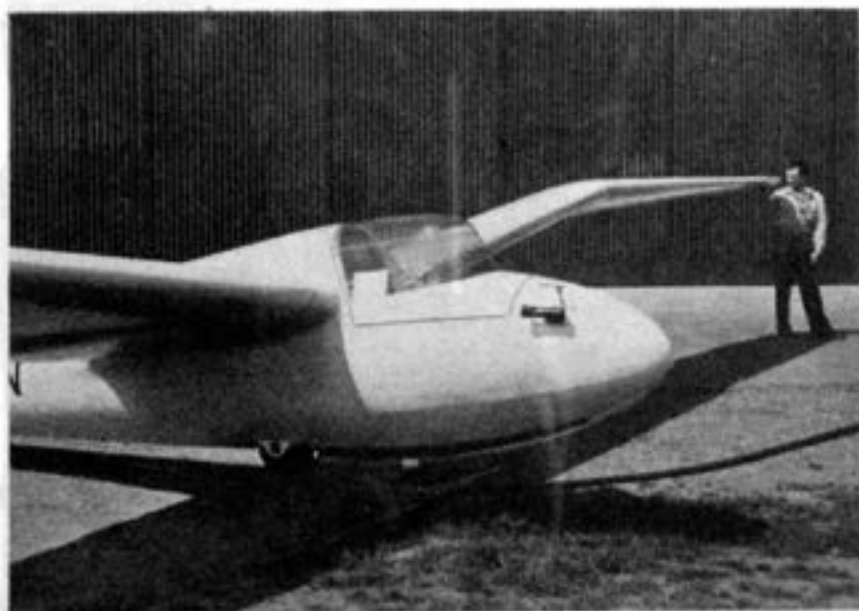
Fig. 37. - Il « Papero » viene condotto in linea di volo. Si nota chiaramente la sistemazione della monoruota fissa dietro il pattino carenato. (Foto M. Galimberti).
