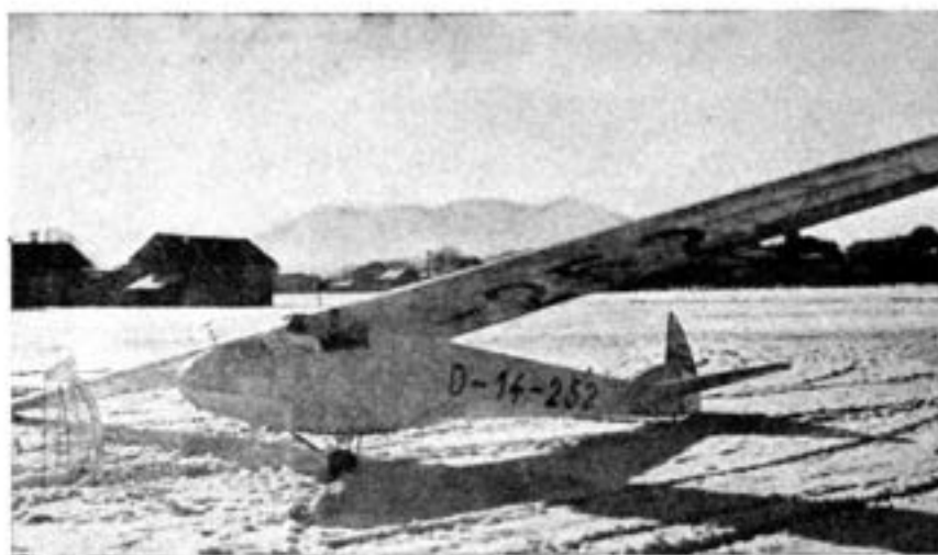
Fig. 34. - Versione modificata del «Mù 17» con installazione del carrello retrattile. La fusoliera è in tubi d'acciaio. (Foto M. Galimberti).
