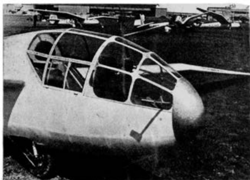
Fig. 53. - Particolare della prora del Rheinland dove si nota la disposizione degli strumenti e la ruota retrattile. (Foto M. Galimberti).
