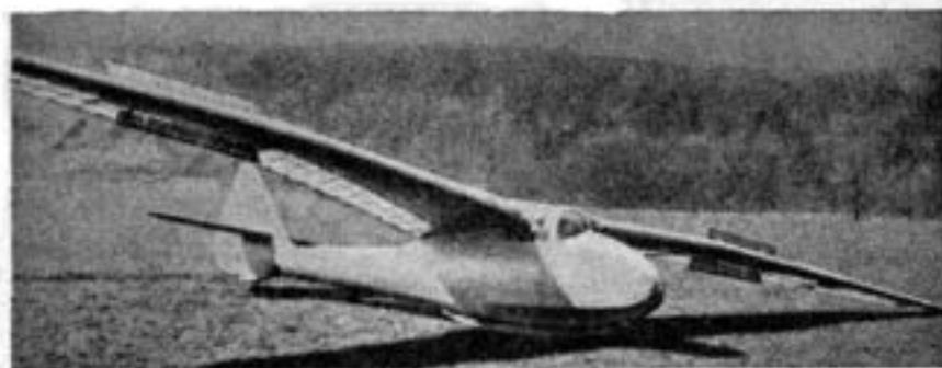
Fig. 50. - Lo svizzero « Spyr IV » con diruttori aperti.
