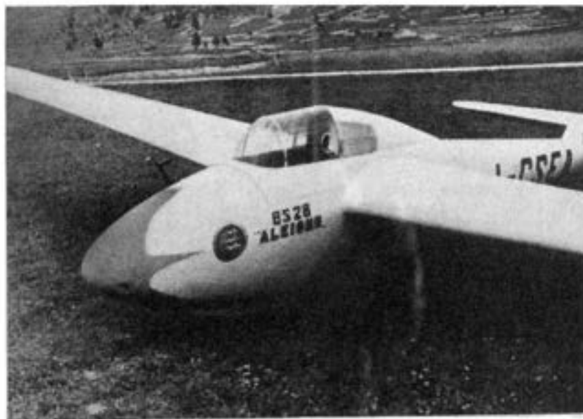
Fig. 25. — La versione affinata dell'Alcione B. S. 28. Alla fusoliera poligonale stata sostituita questa a sezione ovoidale (Foto M. Galimberti).
