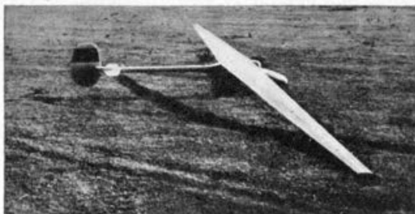
Fig. 62. - L'ardito veleggiatore tedesco D. 30 «Cyrrus» dall'elevatissimo allungamento alare.
