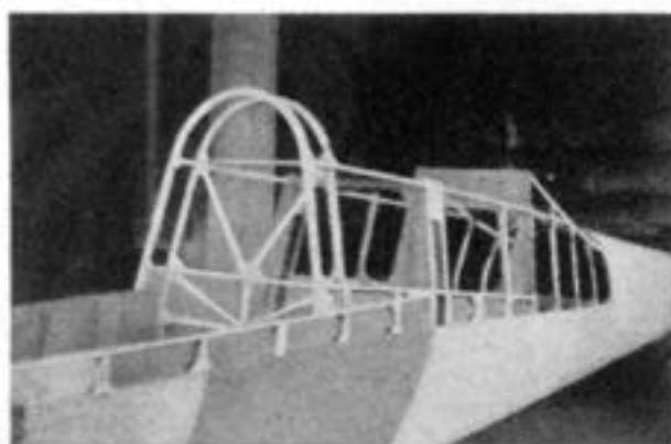
Fig. 72. - Struttura della fusoliera del «Canguro».
