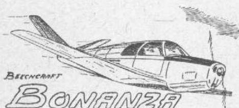
"BONANZA" är ett lågvingat monoplan, som flyger överraskande bra som modell. Är utrustad med noshjul och s. k. stabilifena. Spänvidd 430 mm.
