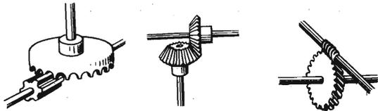
Fig. 171. Trasmissione del movimento tra alberi perpendicolari:
