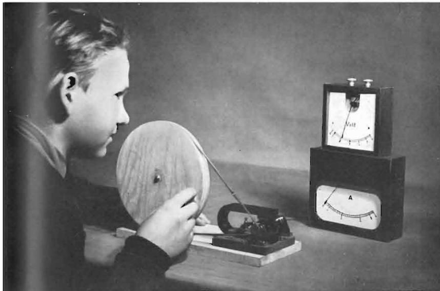
Foto 50. Voltmetro ed amperometro. Si misurano l'intensità e la tensione della corrente fornita da una dinamo.
