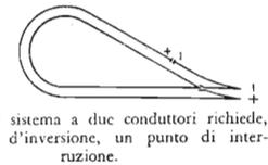
Fig. 476. Il sistema a due conduttori richiede, nelle curve d'inversione, un punto di interruzione.
