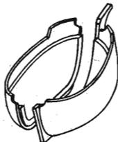
Fig. 599. Le due metà incavate dello scafo con la chiglia inserita nella sua scanalatura.
