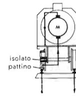
Fig. 475. Sistema a due conduttori senza terza rotaia.
