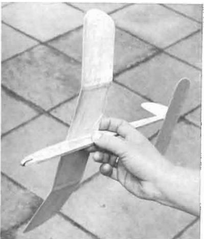
Foto 65. Aliante in balsa con motore ad elastico.
