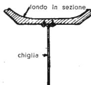
Fig. 579. Fissaggio della chiglia allo scafo.
