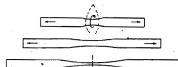
Fig. 881. Foggatura di un tubetto di vetro a punta.
