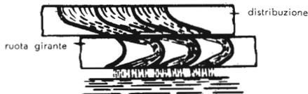
Fig. 208. Turbina con elementi sovrapposti.
