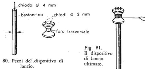
Fig. 80. Pezzi del dispositivo di lancio.
