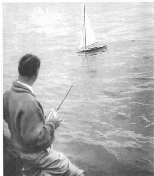
Foto 72. Una barca a vela comandata a distanza. La pressione di un tasto fa ruotare il timone e la barca cambia rotta.
