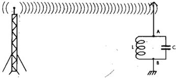
Fig. 419. Circuito oscillante con antenna e collegamento alla terra.
