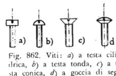
Fig. 862. Viti: a) a testa cilindrica, b) a testa tonda, c) a testa conica, d) a goccia di sego.
