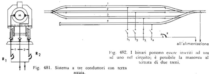
Fig. 481. Sistema a tre conduttori con terza rotaia.
