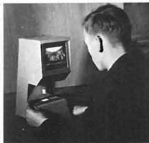
Foto 40. Una sola manovra, e l'apparecchio diventa un visore per diapositive, a proiezione ingrandita.
