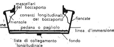
Fig. 606. Sezione attraverso il corpo del battello.
