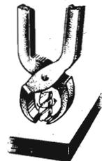
Fig. 819. Estrazione di punta elicoidale rotta.
