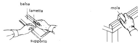
Fig. 543. Come si taglia e si leviga il legno di balsa.
