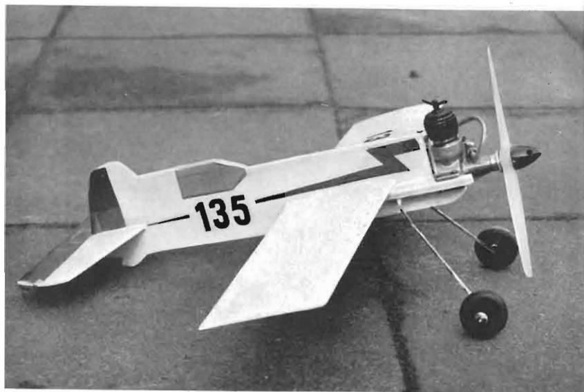
TAV. XIII Foto 26. Modello di aeroplano frenato con motorino Diesel.
