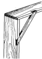
Fig. 757. Congiunzione angolare irrigidita con traversa incassata.
