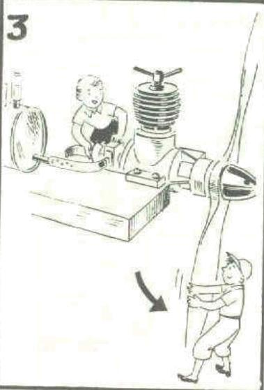
Chockning av motorn sker genom att sätta ett finger på förgasarens insug och samtidigt vrida propellern till vänster tills inga luftbubblor längre kommer upp i slangen. Vrid ej för länge enär motorn annars blir för blöt. Se bild 3. En snaps i avgasportarna underlättar starten bild 4.
