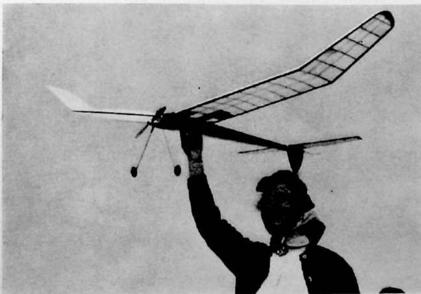
Fig. 141. Un motomodello con deriva inferiore. La disposizione serve ad abbassare il C.S.L. per ottenere determinate condizioni di stabilità.
