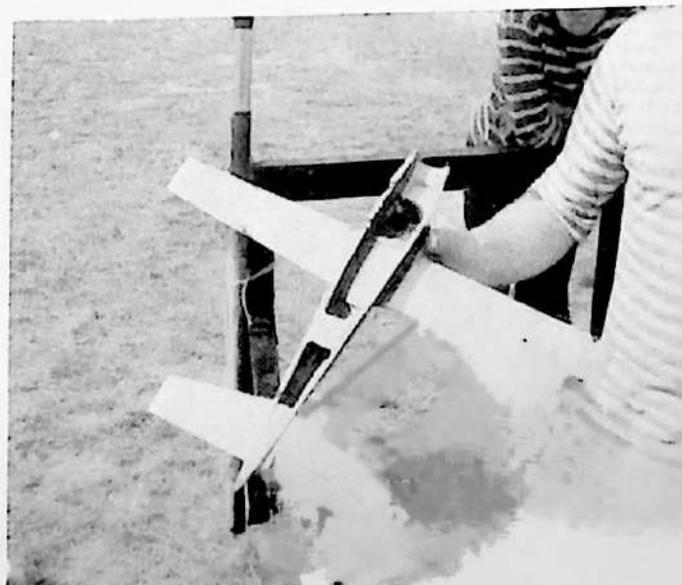
Fig. 352 b. Scocca superiore e inferiore di un tele da velocità III serie con motore da 10 cc. Il serbatoio visibile nella foto di sinistra è un palloncino di gomma. Nella foto di destra sono visibili i diaframmi che contribuiscono all'unione delle due scocche.
