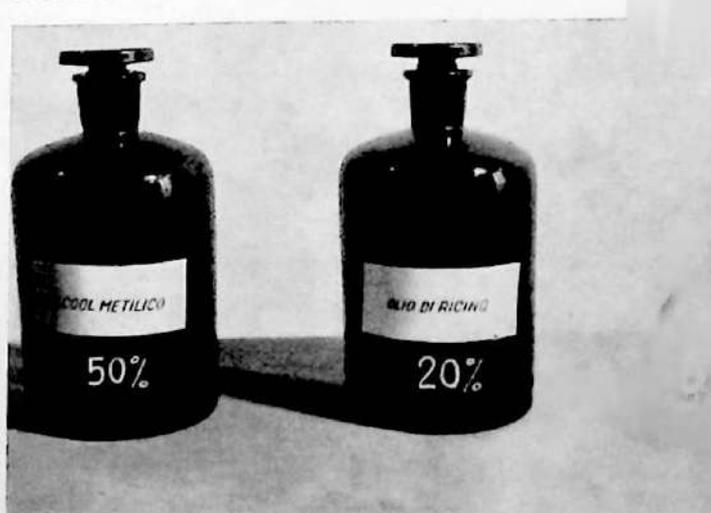
Fig. 214. Miscela da gara per motori *glow plug*: alcool metilico, olio di ricino e nitrometano.
