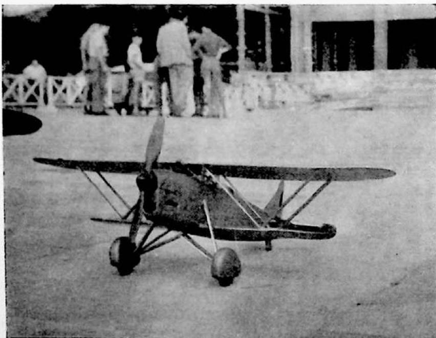
Fig. 166 b. Carrello del biplano da caccia Fiat CR. 32 munito di carenature e controventature di rinforzo.
