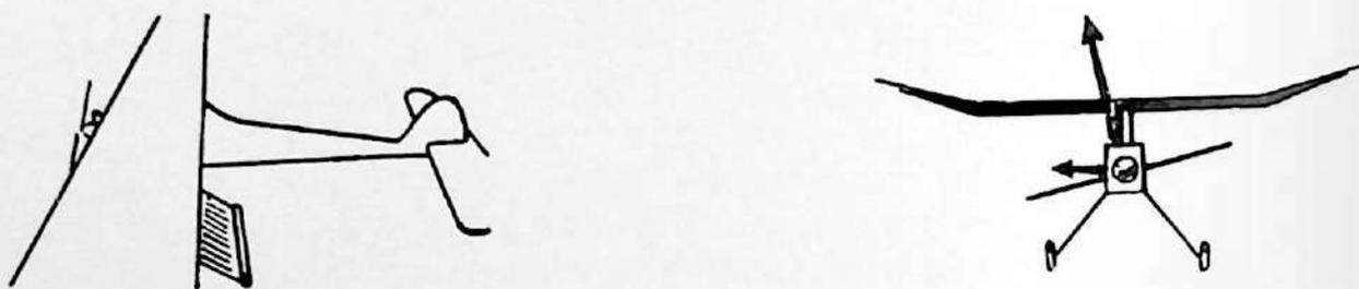
Fig. 320 a, b. L'alettone mobile situato verso l'estremità alare entra in funzione solo in planata (a). Il piano di coda inclinato facilita la virata in planata (b).
