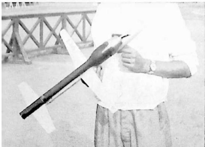
Fig. 17. Un telecomandato da velocità della IV serie con motore a reazione.
