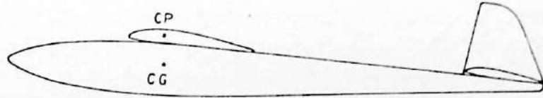
da solo a ristabilire il modello; ma sul piano di quota (che viene a trovarsi ad incidenza negativa) si genera una forza diretta verso il basso di maggiore entità che, superando in intensità la risultante  $R$ , farà ruotare il modello riportandolo nella posizione di equilibrio (fig. 44).
