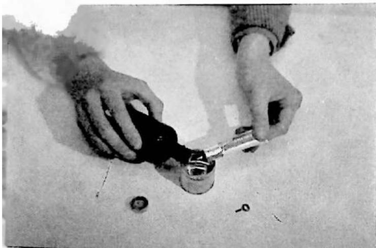
Fig. 171. L'adesivo consigliabile è il collante diluito con solvente.
