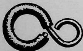
Fig. 244. Il gancio di coda viene sagomato a 8. Nell'occhiello più piccolo si infila il perno che lo blocca alla fusoliera.
