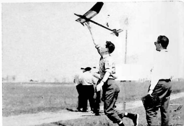
Fig. 297. Ecco la posizione corretta per sostenere il modello e per lanciarlo leggermente cabrato appena il traino ha inizio.
