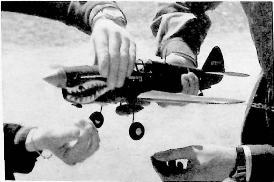
Fig. 370 a. Una perfetta riproduzione del caccia americano Curtiss P-40 War Hawk, rifinita in tutti i particolari. Il motore ha una cilindrata di appena 1 cc.
