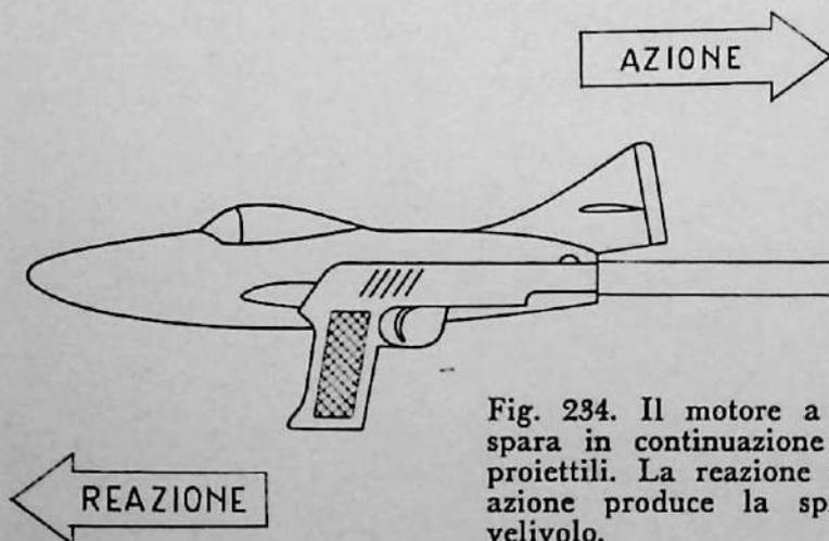
Fig. 234. Il motore a reazione è come una pistola che spara in continuazione gas fortemente compressi anziché proiettili. La reazione che si genera in seguito a questa azione produce la spinta e quindi l'avanzamento del velivolo.
