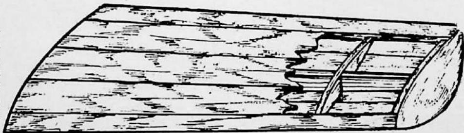
Fig. 103 b. Un esempio di ali rivestite in balsa. Su questa riproduzione del Change Vought F-6 Corsair le ali sono ripiegabili come nell'acroplano vero.
