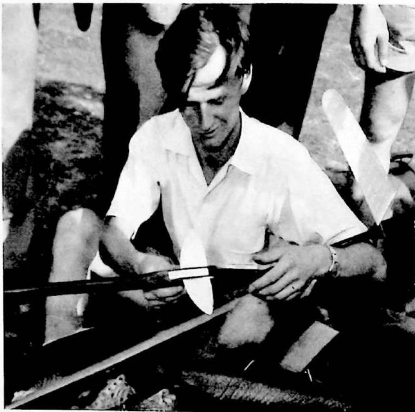
Fig. 101 b. Le baionette orizzontali sono ricavate da compensato duro o da duralluminio. Nella figura la fusoliera e le baionette orizzontali di un veleggiatore da gara.
