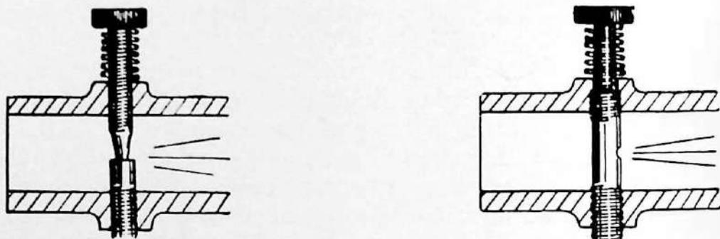
Fig. 204. Lo spillo regola l'afflusso di miscela penetrando o uscendo dallo spruzzatore. In tal modo resta variata la carburazione.
