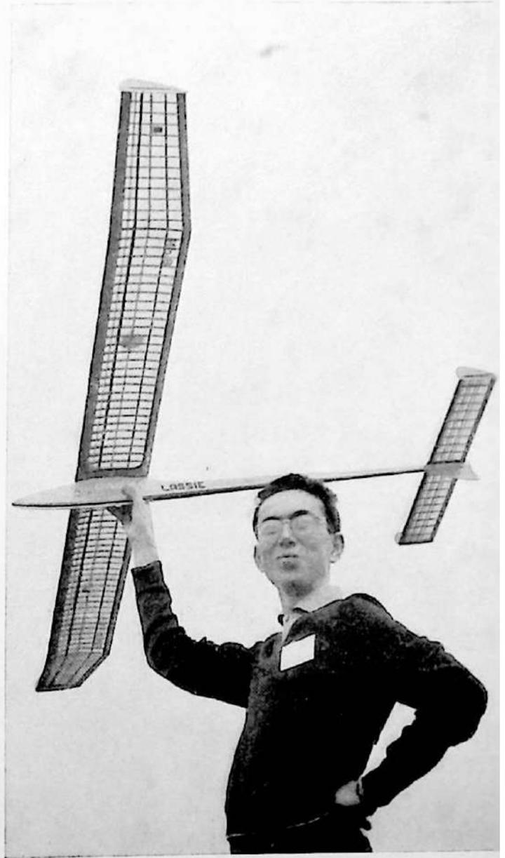
Figg. 81-83. Alcuni esempi di strutture alari. In alto a sinistra un'ala monolongherone; a sinistra in basso un'ala con longherone inferiore di rinforzo; a destra un'ala con longheroni multipli.
