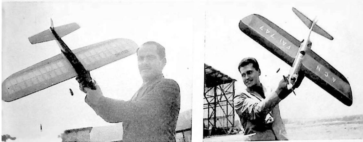
Fig. 362 b. Due esempi di teleacrobatici con flaps e semiala interna a superficie maggiorata. Il motore è di 5 cc di cilindrata.
