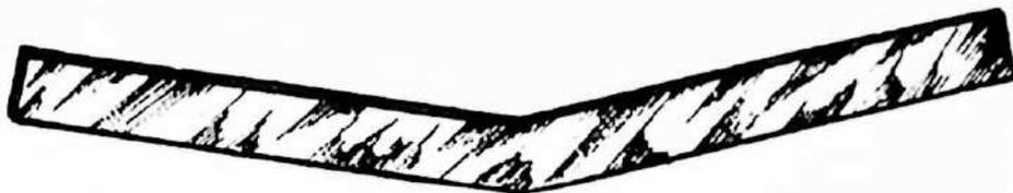
Fig. 99. La baionetta viene fissata all'ordinata di compensato mediante bulloncini o ribattini.
