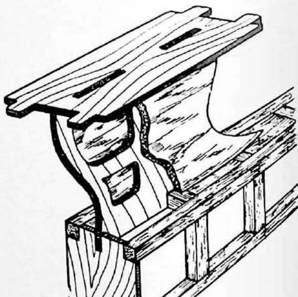
Fig. 119 b. La pinna viene costruita a « sandwich » in balsa e compensato.
