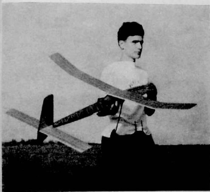
Fig. 126 a. In molti modelli da volo libero il timone orizzontale e quello verticale sono uniti in corpo unico.
