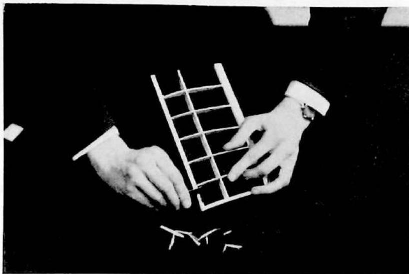
Fig. 95 a. La struttura del terminale deve essere lavorata e rifinita a parte prima del montaggio.
