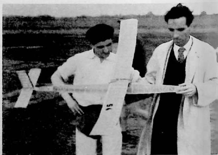
**La matassa.** — La formula consente un peso massimo di 50 gr, 3 dei quali saranno di lubrificante (non si dimentichi che la matassa viene pesata già lubrificata). Se la fettuccia prescelta è il tipo di sezione  $1 \times 6$ , che pesa poco più di 6 gr al metro, ne potremo usare circa 8 m.
