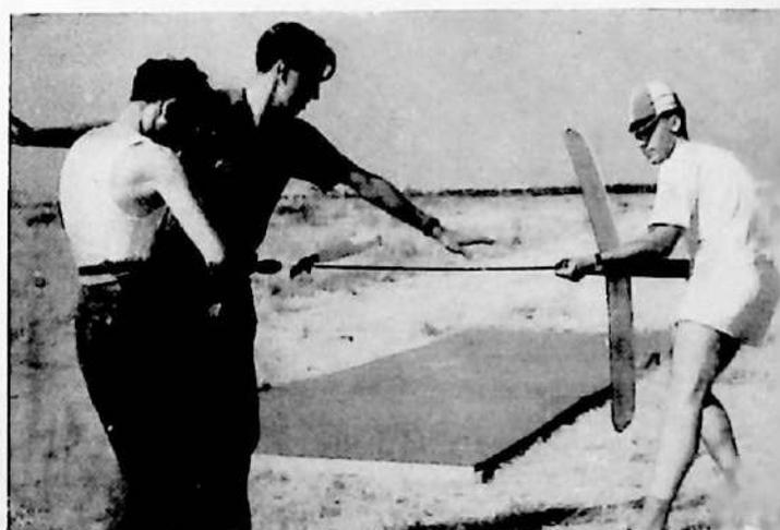
Fig. 311 a, b. Ecco la posizione esatta per far decollare il modello: mentre una mano lo regge per la fusoliera, l'altra tiene ferma l'elica vicino al mozzo (a). Poi si libera l'elica, e quando essa è in piena rotazione (b)... una piccola spinta e il modello è in volo!
