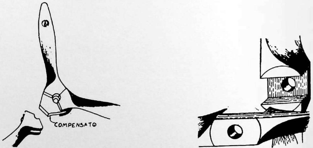
Fig. 276. Le eliche tripale e quadripale per riproduzioni volanti telecomandate vengono realizzate con accorgimenti speciali.
