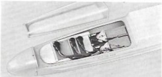
Empfänger, Schaltstufen und Servos sind beim Modell CLOU leicht zugänglich im vorderen Rumpfdrittel untergebracht.
