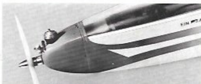
Motor und Tank sind vor dem Kopfspant leicht demontierbar befestigt. Eine glückliche Lösung, die auch aerodynamisch befriedigt.
