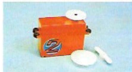
Mit der Präzisionsmechanik des bereits bekannten Tiny-Servos ausgestattet, steht dem Besitzer der Super 2 ein robustes, leichtes und preiswertes Servo zur Verfügung, das sich aufgrund seiner hohen Stellkraft auch für größte Modelle eignet. Der bewährte 16-mm-Mitsumi-Motor ist auch für dieses Servo verwendet. Der Servoverstärker ist nicht wie bei den normalen Tiny-Servos im Servo eingebaut, sondern in den Empfänger integriert.
