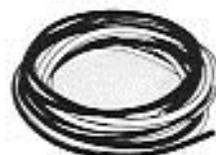
die einpolige, isolierte Kupferlitze besteht aus einzelnen Drähten mit 0,05 mm Ø, Außen-Ø der Litze 2,2 mm.
