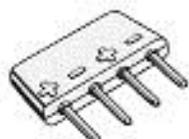
Der Bausatz besteht aus 4 hartversilberten Steckerstiften mit 2 mm Ø und einer linken und rechten Schalenhälfte aus Kunststoff. Die Schalenhälften sind mit Polbezeichnungen versehen.
