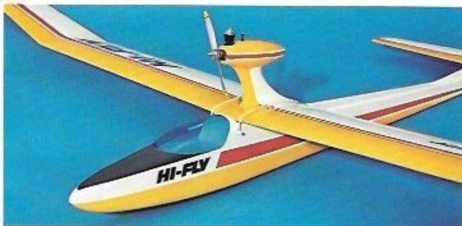
Deshalb spricht HI-FLY auf die geringste Thermik an und segelt bereits bei schwächstem Auftrieb am Hang. Einfacher Kunstflug ist möglich. Bei entsprechender Trimmung kann man HI-FLY natürlich auch bei stärkerem Wind fliegen. Im Hochstart läßt sich das Modell sicher bis auf die maximale Ausklinkhöhe ziehen und zeigt keinerlei Tendenz zum Ausbrechen.
