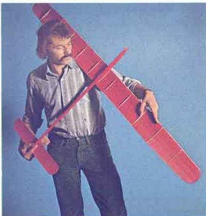
ten bereitet. Ausgezeichnete Hochstart- und Kurven-Eigenschaften auf Grund der Knickflügel und eine zuverlässige Kurvensteuerung sowie eine sichere Thermikbremse vervollständigen die Beschreibung dieses echten Wettbewerbsmodells.
