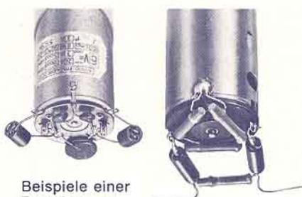
Beispiele einer Entstörung an unterschiedlichen Motoren
