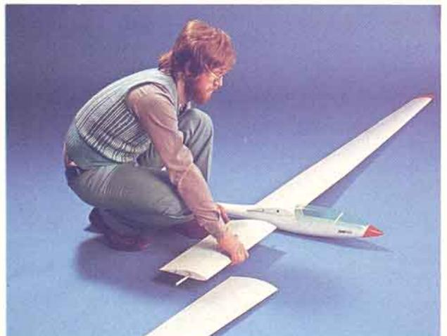
Die Abbildung zeigt die einfache Montage eines Zwischenstückes zur Vergrößerung der Spannweite.
