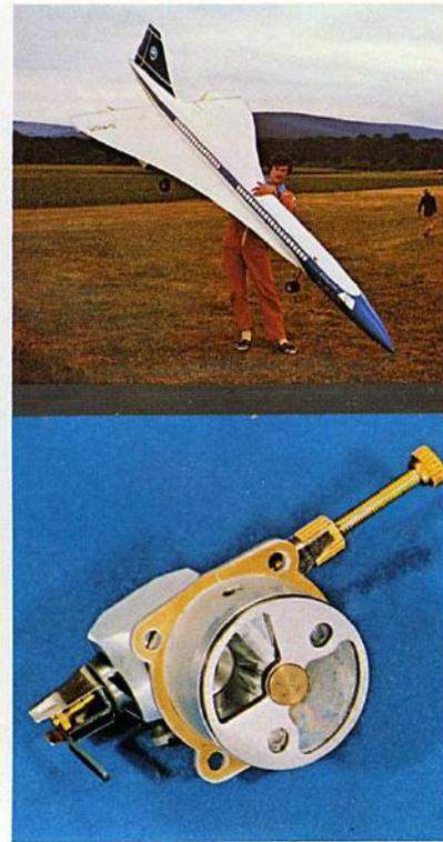
Ein 10 ccm Modellmotor der absoluten Spitzenklasse. Die Gemischzufuhr wird über einen Heckdrehschieber gesteuert. Vom Kurbelgehäuse gelangt das vorkomprimierte Gemisch über drei Spülkanäle in den Verbrennungsraum (System Schnürle). Der Kolben ist ein Flachkolben. Die tief herabgezogene Verrippung des Gehäuses sorgt zusammen mit dem schwarzen Zylinderkopf für einen ausgewogenen Wärmehaushalt dieses Hochleistungsmotors.
