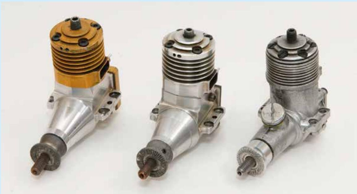
I primi motori Cipolla 2,5 cc per F2C Team Racing. A sinistra, il prototipo numero 6 con carter ricavato dal pieno e testa anodizzata in oro per migliorare il raffreddamento. In centro, il prototipo numero 1 del 1970: carter ricavato dal pieno, tappo posteriore in magnesio con venturi orizzontale. A destra, il primo prototipo con carter in fusione del 1966-1967, scarico posteriore, alimentazione modificata con venturi posteriore inclinato.
