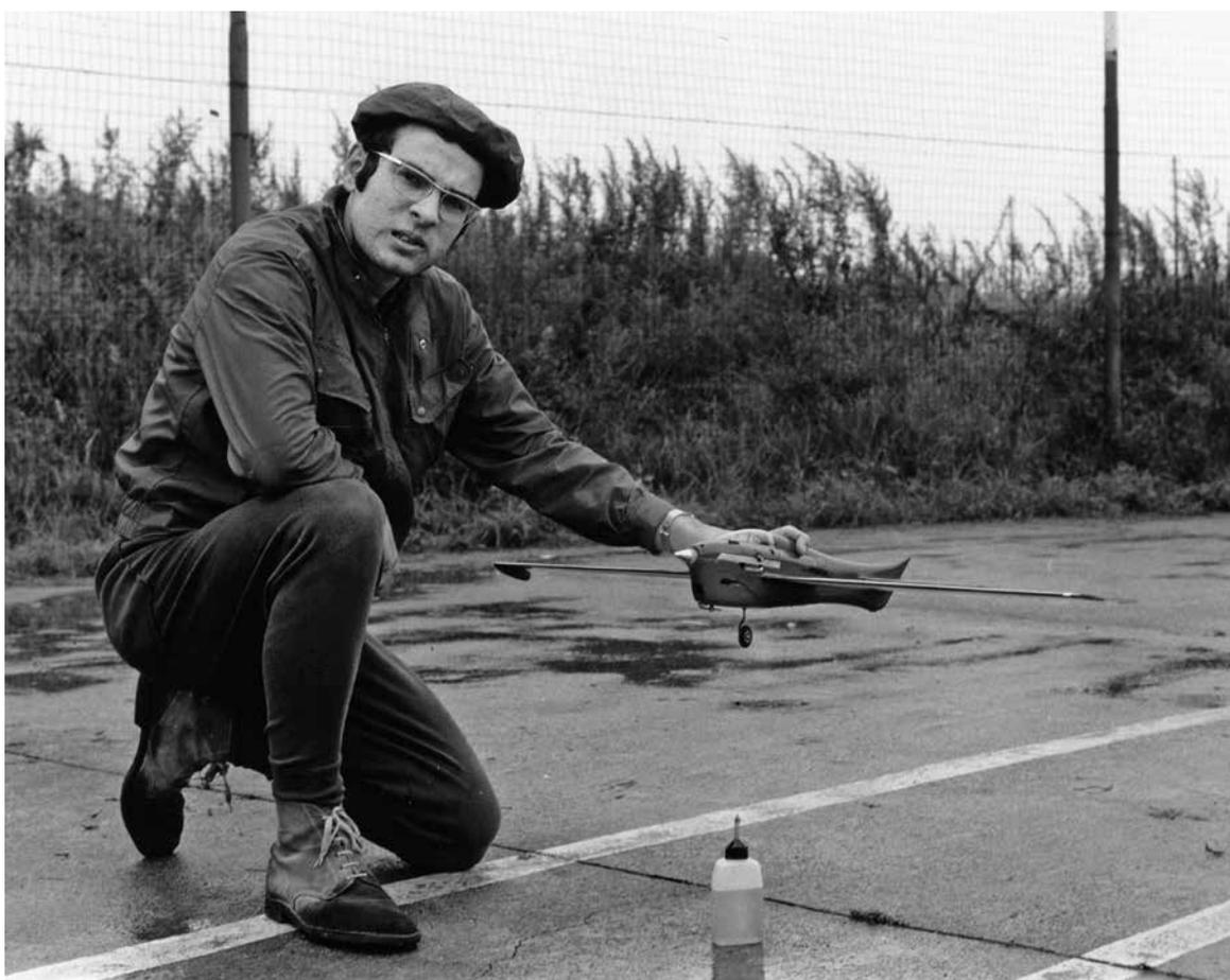
Luigi Ferroni alla Mille Giri 1968 durante il riscaldamento motori. In primo piano, la spruzzetta di plastica allora di uso normale per il riempimento rapido del serbatoio. Ben visibili le linee filanti della fusoliera e il carrello monoruota.
