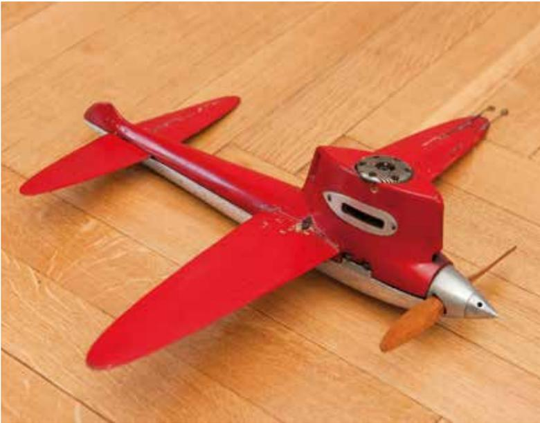
Sopra, il modello Classe B di Marco Contini che portò al debutto in Italia il nuovo motore Fox 29 Racing. Il modello, conservato fino a oggi, ha fusione inferiore in magnesio a tutta lunghezza. La parte superiore della fusoliera era fissata alla fusione con una vite all'attacco di ciascuna semiala e con due viti in coda, che bloccavano anche il timone orizzontale. Elica Tornado 7x9.
