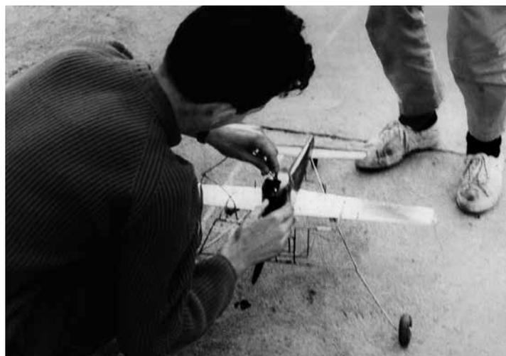
Per controllare un modello con il monoline si provarono manopole che convertivano il movimento abituale verso l'alto o il basso nella torsione del cavo. Questa manopola è stata costruita, con l'abitudine cura delle
