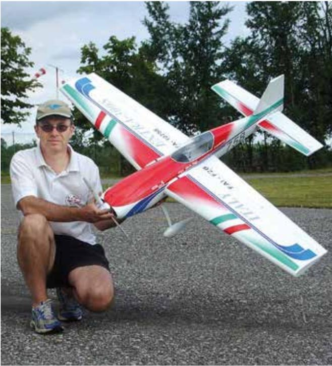
Sopra, Alberto Maggi, vincitore della categoria F2B Acrobazia alle Ambrosiane 2009, posa con il suo modello di produzione ucraina. Completamente smontabile per il trasporto, era una semiriproduzione dell'Extra 300S con apertura alare 1.500 mm, peso 1.850 gr, motore Stalker 76 a due tempi, elica 14 x 5.5.
