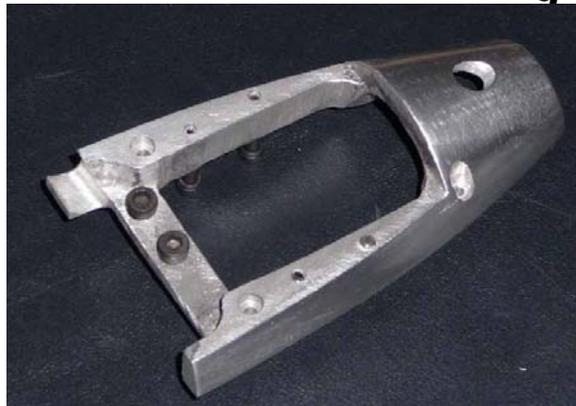
Sotto, il muso del modello con la sede del motore ed il suo condotto di raffreddamento per allontanare l'aria calda, le boccole di alluminio annegate nel legno che servivano per fissare la fusione e due per il serbatoio tipo uniflow con lo sfiato che fungeva anche da schizzo per il cicchetto, infatti il motore diesel permette di essere avviato a caldo con il contraccolpo.
