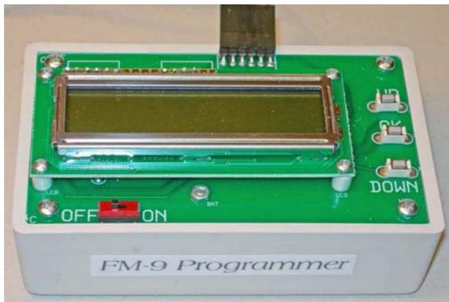
**batteria-regolatore disconnesso!)** e il collegamento a 6 fili con il programmatore connesso. Il segno rosso è sulla destra. Ora **si terrà premuto il pulsante Start / Stop e, contemporaneamente, si accenderà il programmatore.**
