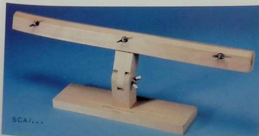
**SCALETTO DI MONTAGGIO** in robustissimo legno di faggio evaporato. Consiste di due ganasce, regolabili con galletti, che hanno funzione di morsa per bloccare la chiglia del modello. Inoltre uno snodo permette l'inclinazione voluta allo scafo. Lo scaletto è da bloccare al banco di lavoro mediante due morsetti, non compresi nella confezione.
