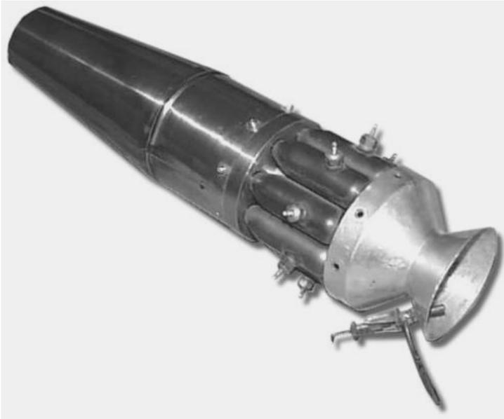
*Ancora più folle appare l'uso di uno spruzzatore davanti al compressore dove aria e combustibile erano miscelate prima di essere compresse. Anche se l'esemplare che compare nelle foto ha uno scarico mostrante tracce di essere diventato almeno caldo, le camere di combustione mostrano minori o inesistenti segni, ad indicare chiaramente che non ha mai girato come invece indica la pubblicità.*
