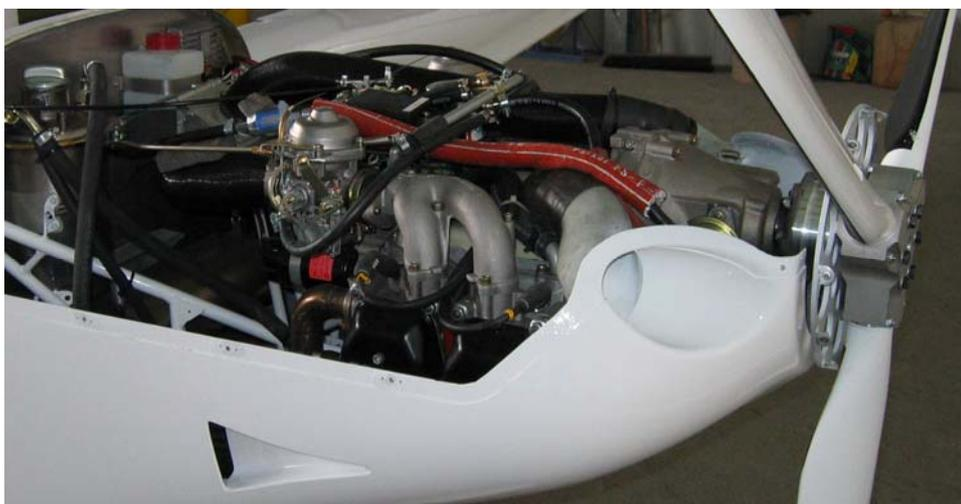
*Figura 3: Installazione del motore Rotax (80 CV) sul velivolo Focus*
