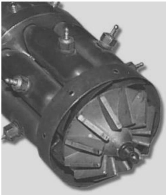
*Il compressore mostra di essere del tipo radiale molto semplice e grezzo (centrifugo) con palette incredibilmente spesse e senza un vero diffusore. Da notare anche che ogni piccola camera di combustione ha una sua candela glow e che il flusso dell'aria dal compressore a queste camere deve essere incredibilmente turbolento a causa degli angoli acuti del loro percorso.*
