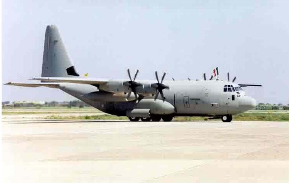
*Figura 16: C130 J motorizzato da 4 Turboprop AE 2100*
