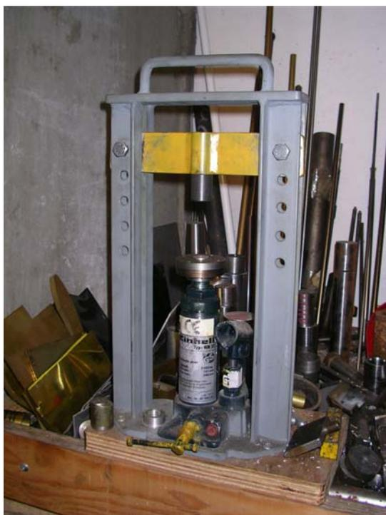
Pressa idraulica autocostruita con un crick per automobile
