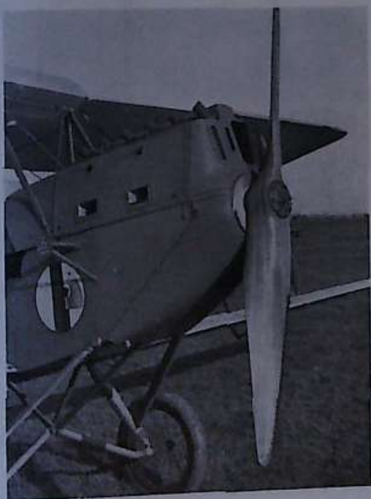
Tipo terrestre con motore a cilindri in linea raffreddati ad aria.
