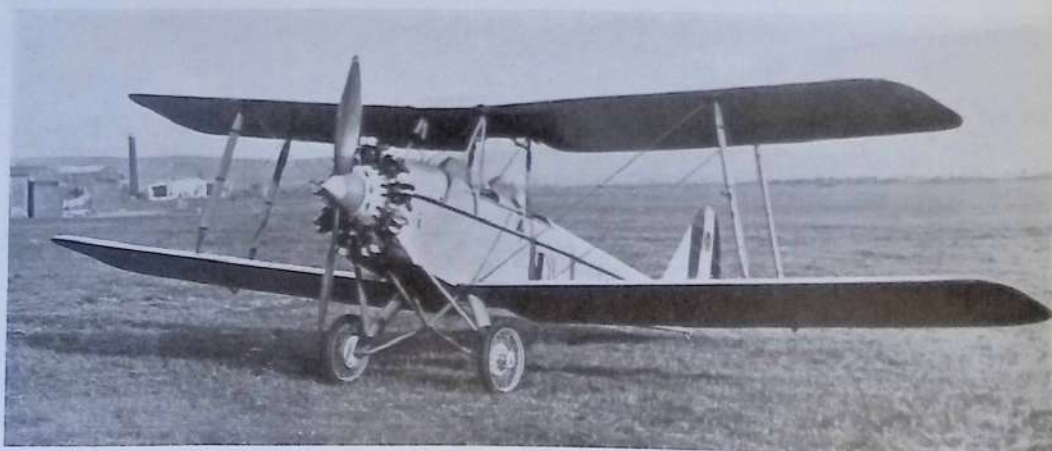
Tipo con motore a stella raffreddato ad aria Motore Walter NZ 130 HP.
