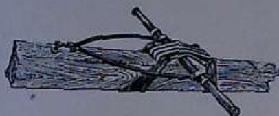
Asse delle ruote posteriori molleggiamento con cordone elastico.
