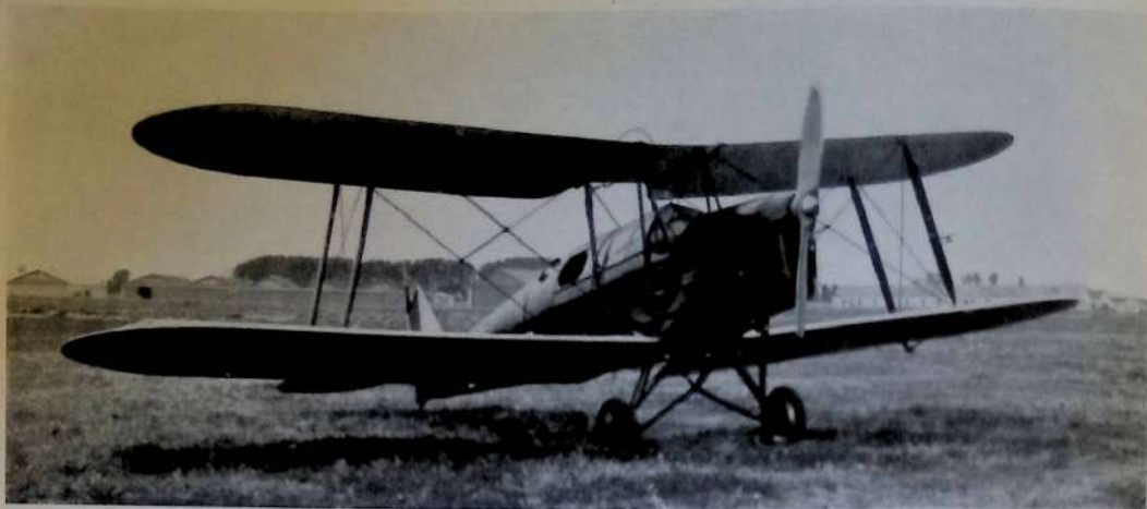
Tipo con motore invertito a cilindri in linea raffreddati ad aria. Motore Gypsy 130 HP.
