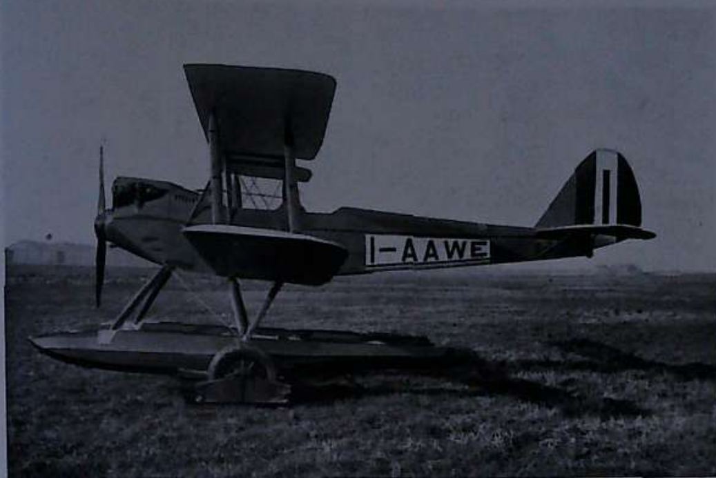
Tipo con motore a cilindri in linea raffreddati ad aria.
