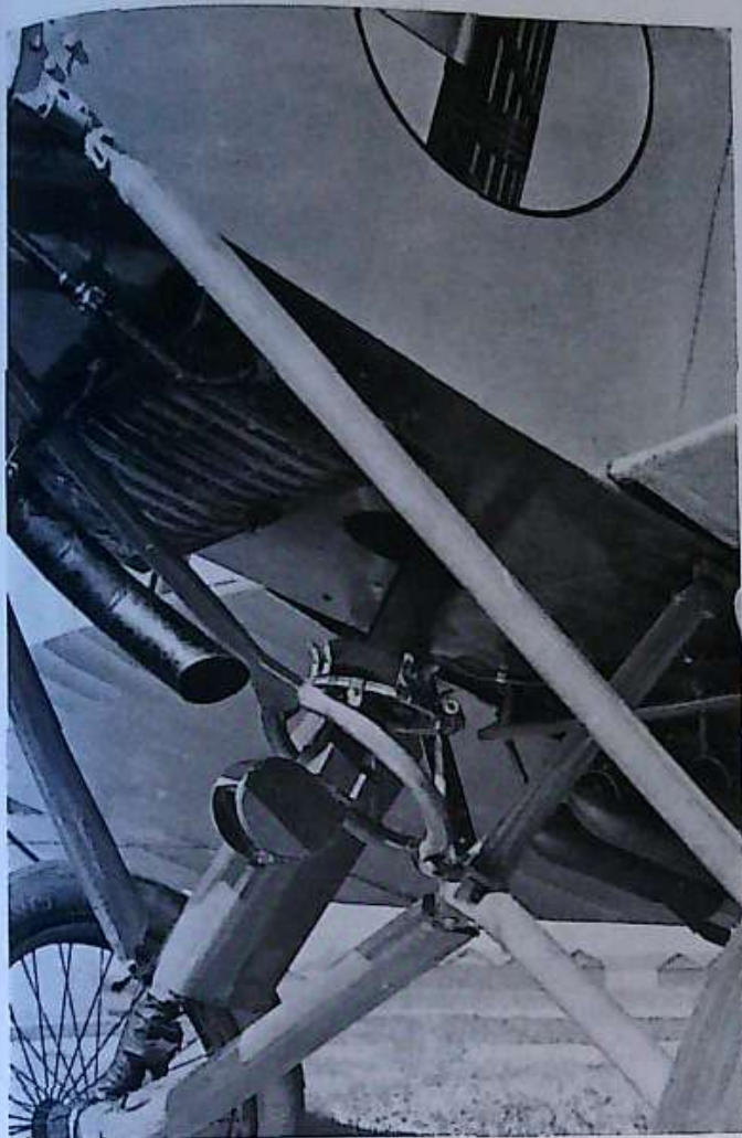
MONOPLANO CAPRONI 100 con sistemazione per il lancio delle bombe e con canocchiale di puntamento, per istruzione ed allenamento.
