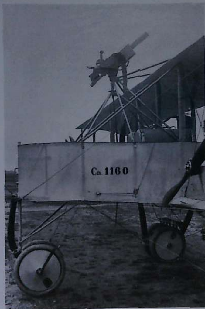
Montaggio di un cannoncino a tiro rapido di 25 m/m su un biplano Caproni 33.
