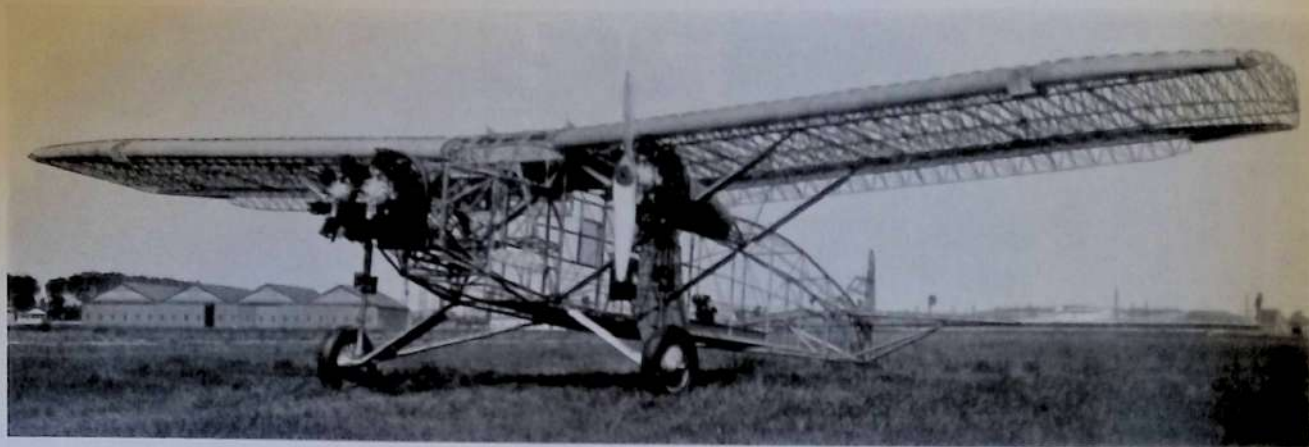
Vista d'insieme dell'apparecchio disintelato, ad ala metallica.
