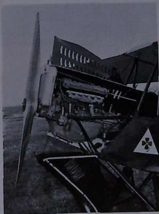
Tipo con motore d'automobile Alfa Romeo di 2500 cm. 3
