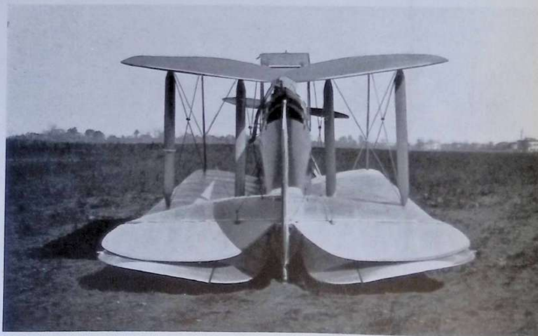
BIPLANO CAPRONI 100 Viste diverse mostrandoti il ripiegamento delle ali.
