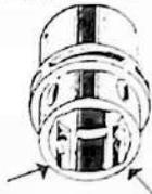
Zylinderbuchse mit neuartigen Überströmkanälen für höhere Leistung
