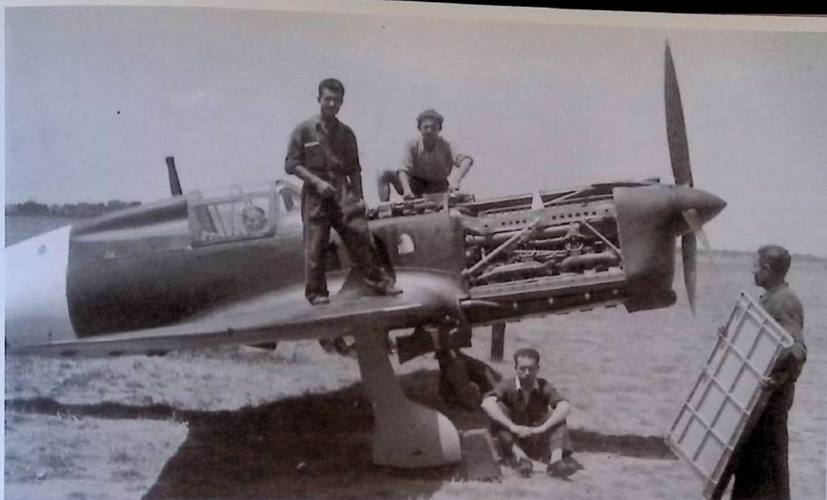
153. Questo motorista acconsentì a togliere il cofano (in legno, ma ben rinforzato) per farmi vedere il Delta... ci stava "tutto e appena", coi suoi 850 Cv, raffreddato ad aria.
