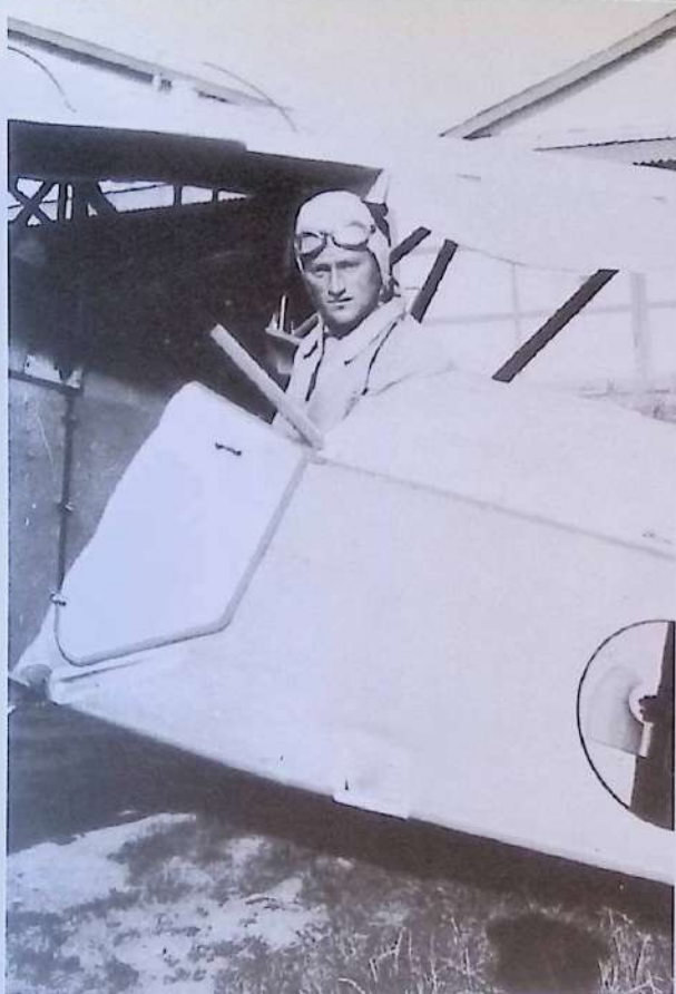
43. In questo dettaglio l'AS1 con Sangalli nel 1933 ci appare in tutta la sua "semplicità" costruttiva: tipico lo sportellino di stile automobilistico... Sangalli conseguì poi a Cameri il brevetto militare.
