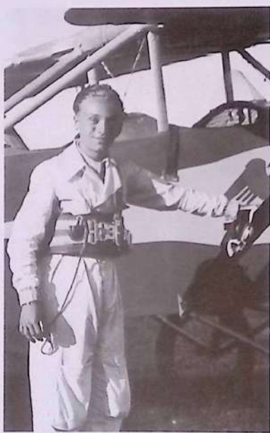
61. L'AS1 era di facile pilotaggio e sicuro nell'uso. L'ala "aperta" sopra il pilota, facilitava l'entrata - uscita e i due lunghi montanti all'indietro davano protezione.
