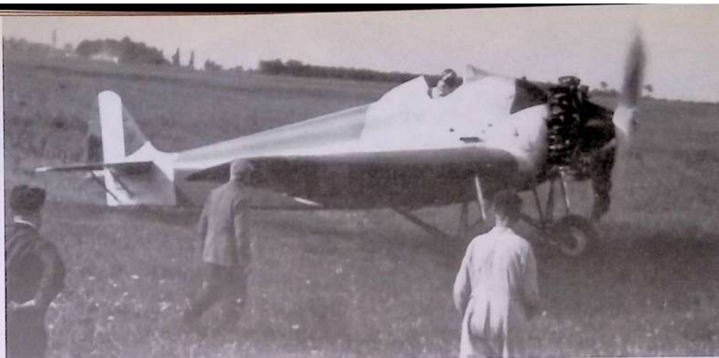
76. Parliamo un attimo degli aerei AP1 (Assalto Pall.1) che sono stati progettati dal 1934: vediamo appunto il prototipo al primo volo senza cofano motore, molto rustico...
