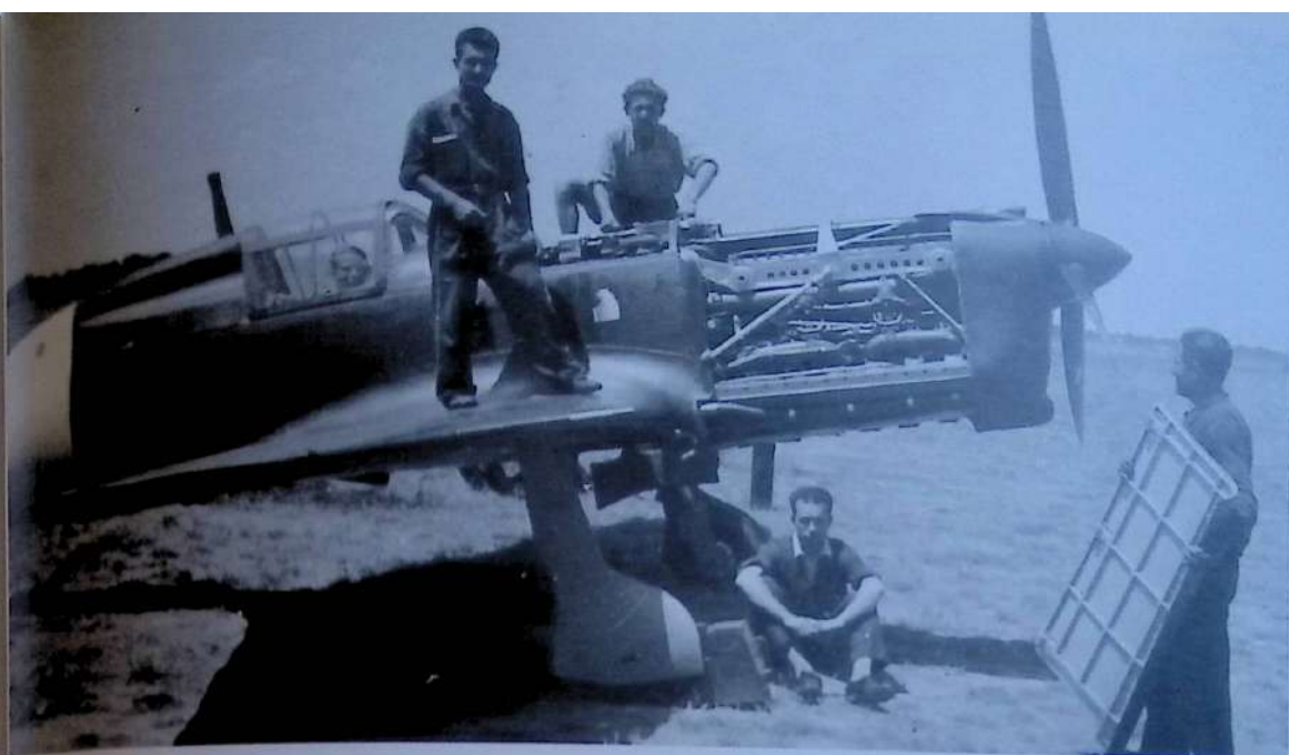
153. Questo motorista acconsenti a togliere il cofano (in legno, ma ben rinforzato) per farmi vedere il Delta... ci stava "tutto e appena", coi suoi 850 Cv, raffreddato ad aria.
