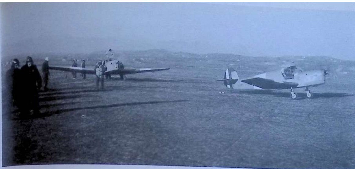
130. Autunno 1942: il SAIMAN 202 (costruito a centinaia per le scuole) era utilizzato per addestramento al volo cieco... (senza visibilità). L'istruttore - a fianco dell'allievo - gli stendeva intorno una tendina. C'era una grande bussola... Si volava verso il Gran Sasso e la Maiella, 30' a volo!
