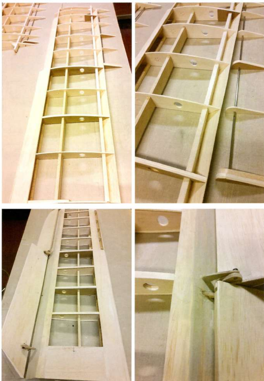
Profilo alare e dettagli interni dello Stinson L-5 originale
