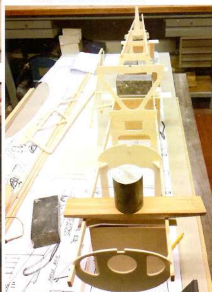
Il direzionale pronto per essere montato sulla fusoliera
