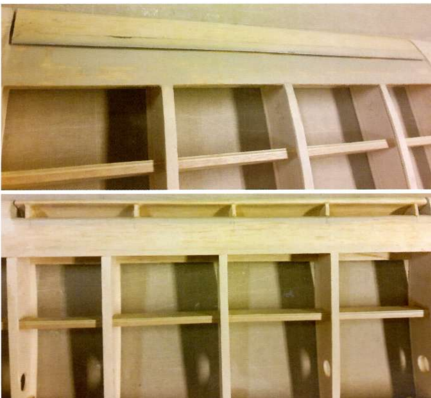
Lo Stinson L-5 è dotato di slats fissi, che sono stati accuratamente riprodotti sul modello
