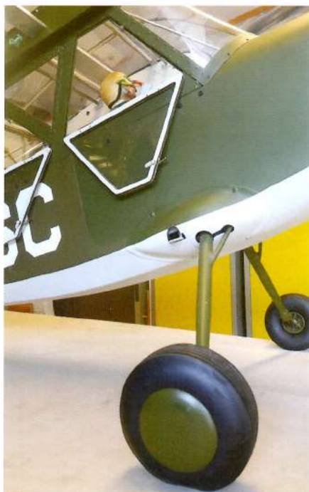
Anche le gambe del carrello sono verniciate
