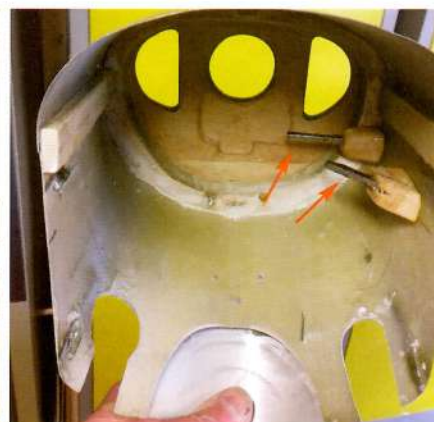
Un sistema ingegnoso per arrivare agli spilli del carburatore
