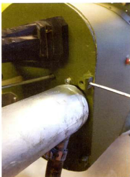
Il sistema utilizzato per fissare la carenatura motore
