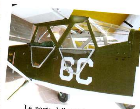
Le porte della cabina sono apribili sul lato sinistro
