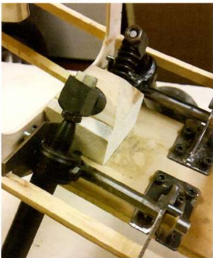
Il carrello di atterraggio è stato accuratamente replicato, ma il sistema di ammortizzazione è basato su molle invece che sul sistema idraulico utilizzato sul full size
