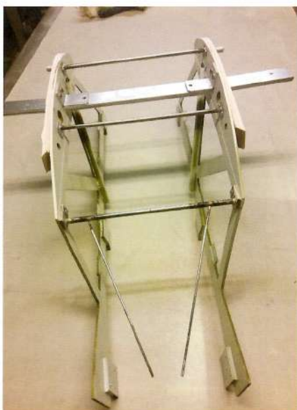
La parte centrale della fusoliera include parti in metallo come i montanti saldati e la giunzione delle semiali
