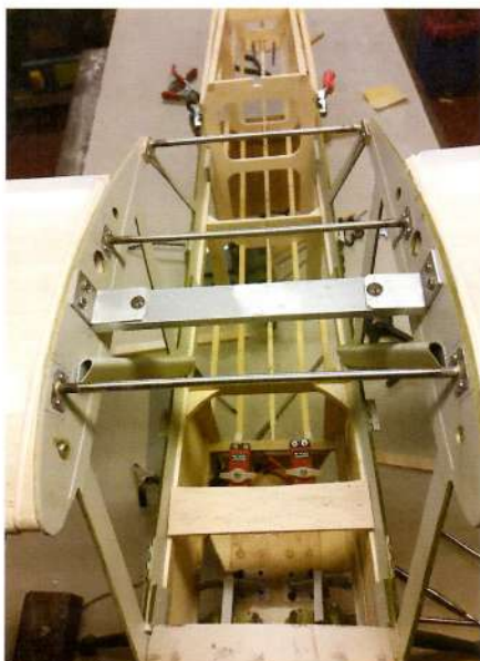
La parte centrale della fusoliera include parti in metallo come i montanti saldati e la giunzione delle semiali
