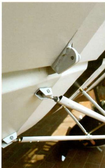
I montanti alari sono incernierati
