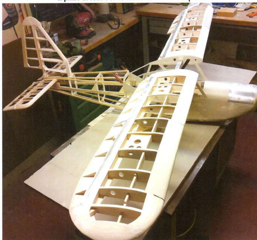
Uno dei vari "montaggi di controllo" necessari durante la costruzione
