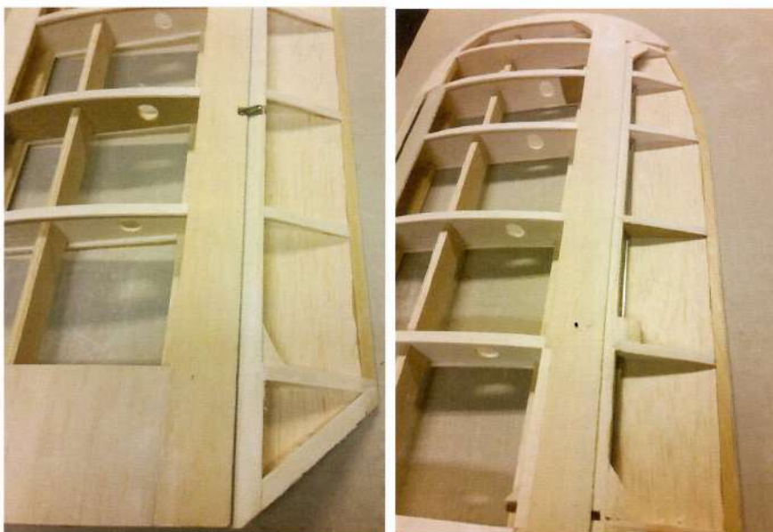
I flap e gli aiettoni sono pronti per essere rivestiti in Oratex
