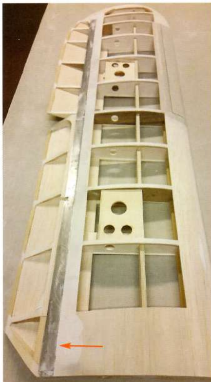
Una striscia di alluminio di 0,3 mm è stata aggiunta per ottenere lo spazio esatto richiesto tra l'ala e le superfici di controllo
