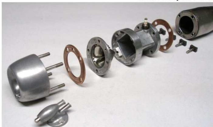
Il Minijet smontato. A differenza del Dynajet, tutti i componenti sono ricavati da fusione.
