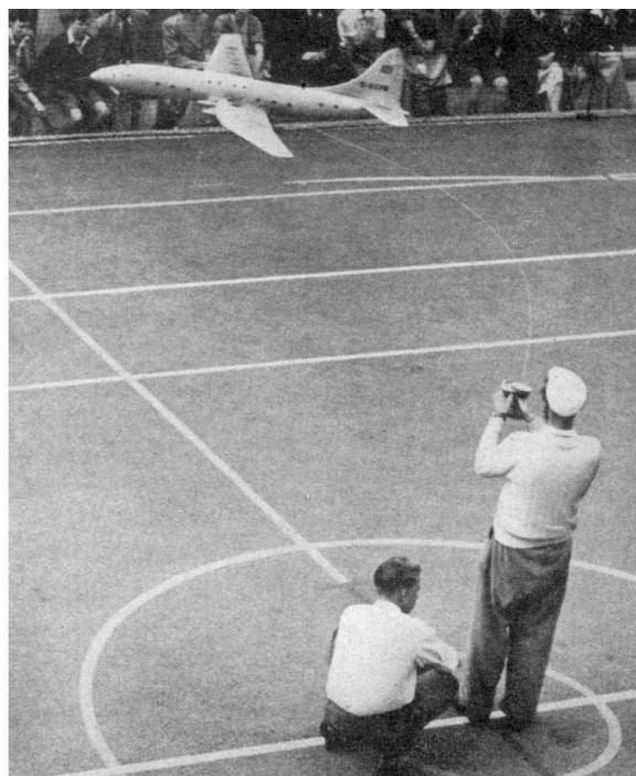
**Il Bristol Brabazon di Peter Holland a terra, in volo e nei particolari del meccanismo di retrazione del carrello. Era propulso da quattro *Elfin 1.8* e sfoggiava un'apertura alare di tre metri.**
