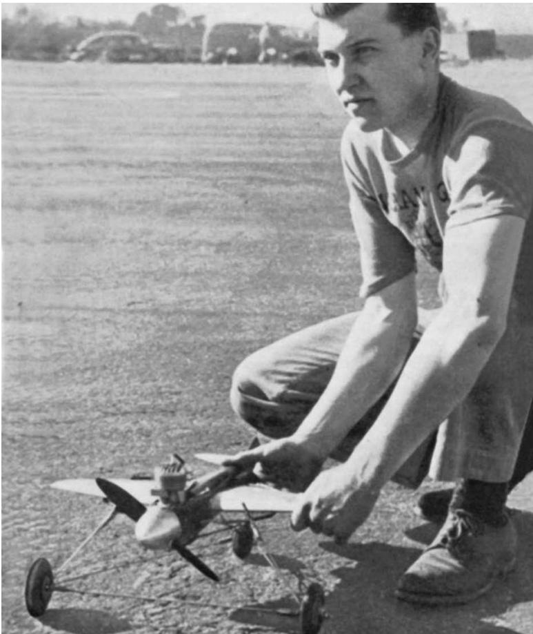
1944, alle prime uscite, l' Hill Special sparò un sensazionale 160 Km/h, pur disponendo di un semplice *Ohlsson 23*, il classico motore dei volatori della domenica. Anche perché il buon Bob aveva fatto a meno del carrello, adottando saggiamente un dolly che lasciava a terra al momento del decollo.
