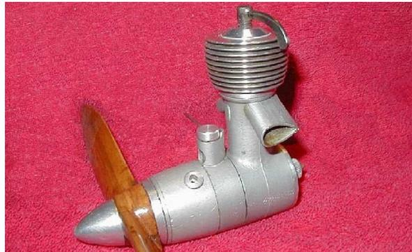
L’*Atomatic 5* della *Aviominima*. Il 4, usato sullo *Swing*, aveva gli scarichi non inclinati.
