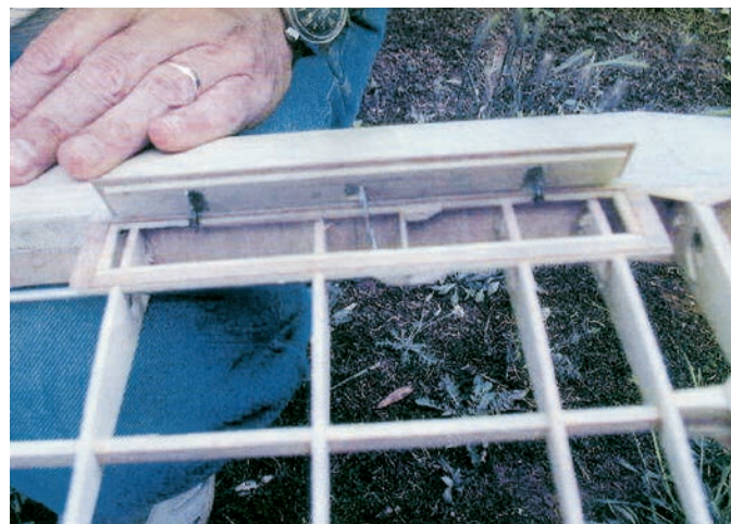
In alto: l'Arcore pronto per il collaudo. A fianco: un particolare del diruttore e l'autore col modello da rivestire. Qui sotto: il primo atterraggio dopo un collaudo perfettamente riuscito.
