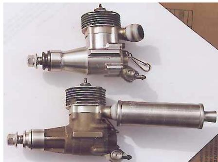
Fig.5: Il Lothar Hentschel, carter in due pezzi e aspirazione a disco rotante
