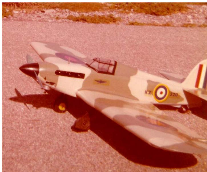
L' Hurricane costruito da Luigi Massara nel 1971 da kit Aviomodelli. Il modello era preziosamente rifinito, montava un G20 Diesel con elica 8/6
