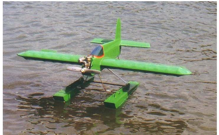
Questi due idrovolanti VVC sono stati costruiti da Bruno Massara verso la fine degli anni '80. Il primo a sinistra è un modello a tavoletta con una apertura alare di 65cm, motorizzato con un Cipolla 1,5. A destra il Polpetta, apertura alare 110cm, G20 Glow, cavi da 16m., peso in configurazione idrovolante 600g. Il modello esegue i looping ed il volo rovescio. Qualcuno in Estate vuole organizzare un raduno per idrovolanti VVC?
