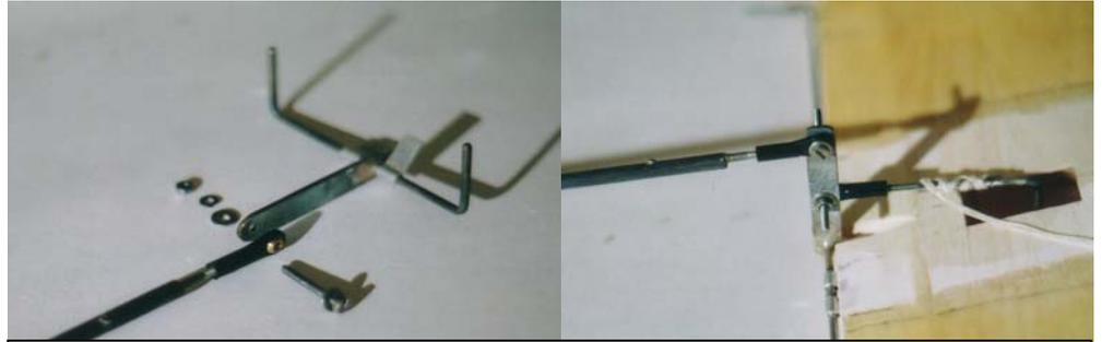
Fig.3 – A sinistra l'uniball già collegato alla barra in carbonio e pronto per essere montato alla squadretta dei piani di coda.
