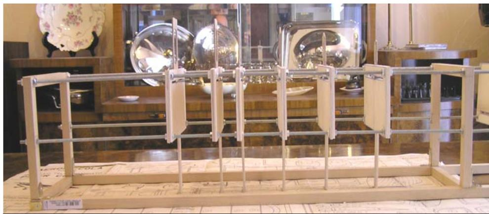
Lo scaletto ideato dall'autore in una vista laterale. Sono ben visibili: Il telaio in legno duro 15x15; le guide superiori e inferiori costituite da barre filettate da 5 e 6mm; le "piastre" o "ordinate" dello scaletto che servono a fissare le ordinate della fusoliera.
