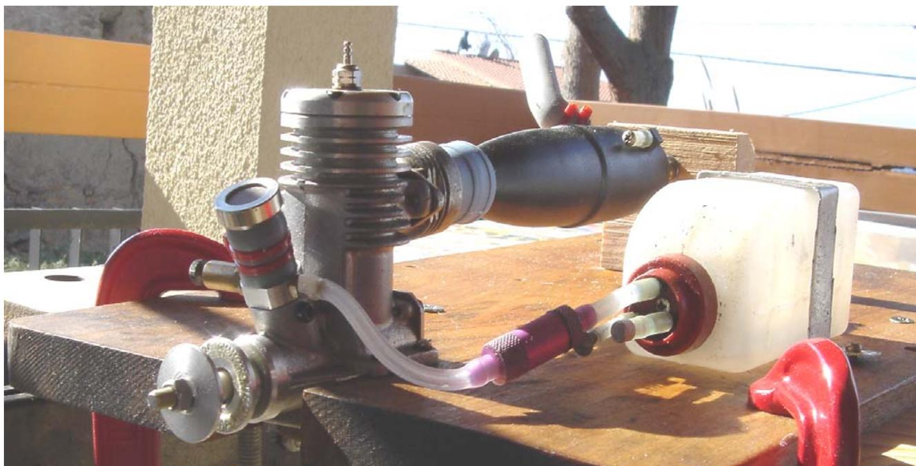
Il BALDINI .60 al banco prova durante il rodaggio. Il silenziatore usato è quello dello Stalker.
