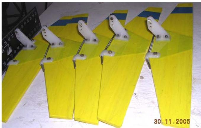
**Figura 4 – I piani di coda assemblati.**
