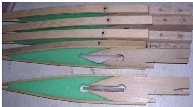
Figura 2 – La centina centrale dell'Armageddon assemblata.
