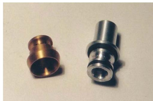
**Foto 2 – A sinistra il venturi originale, a destra il venturi autocostruito con il secondo O-ring nella parte interna al carter.**
