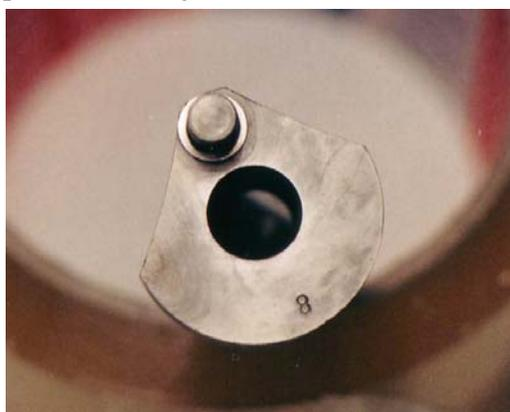
**Foto 3 – L’albero motore con il volano fresato.**
