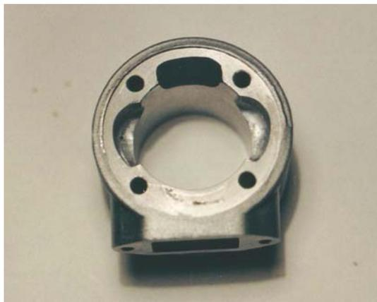
Foto 4 – I travasi del cilindro fresati.
