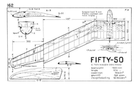
"PADESÁTIGRAMOVÝ" WAKEFIELD Model byl postaven jednou pro 80g svazek a dvakrát pro 50g svazek. Provedení se od sebe liší jen dělkou přední části dvoudilného trupu. Přední díl má kostru z balsových lišt 3 × 3 mm a potah z 1,5 mm balsy. Zadní díl je z balsových lišt 3 × 3 mm a diagondl 2 × 3 mm. Svazek je uchycen na duralově trubce, která se zasouvá do uchy-cení z překližky a balsy zezadu
