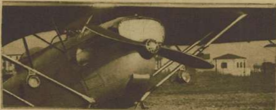
Fig. 1. — Elica in legno montata su un nostro vecchio ricognitore: A. 120 - Mot. Fiat A. 22 T.
