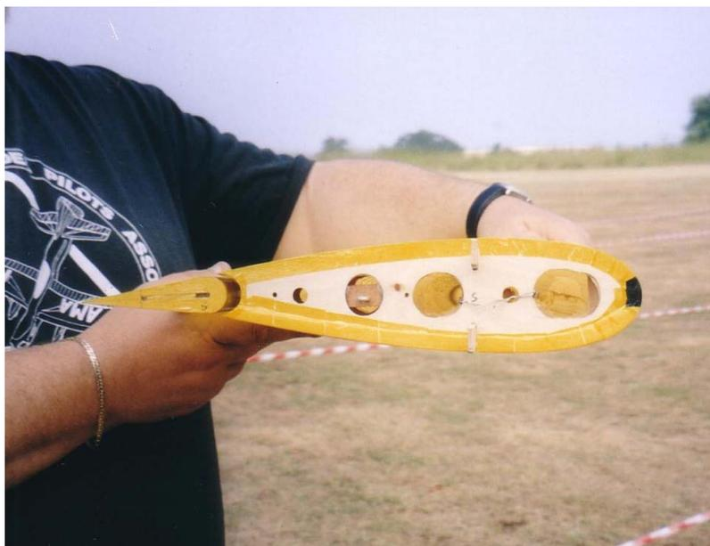
**L'originale sistema di incernieramento dei flaps del Benny 2 di Ennio Marra. Il b.e. del flap ruota nel b.u. semicircolare dell'ala. La struttura è bellissima e molto complessa da costruire.**
