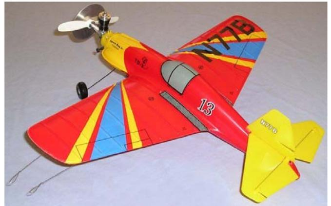
**Il TD-3 munito del Training Aid Kit: un'ogiva in gomma per ammortizzare gli impatti ed un disco di alluminio per ridurre l'efficienza dell'elica e la velocità di volo**
