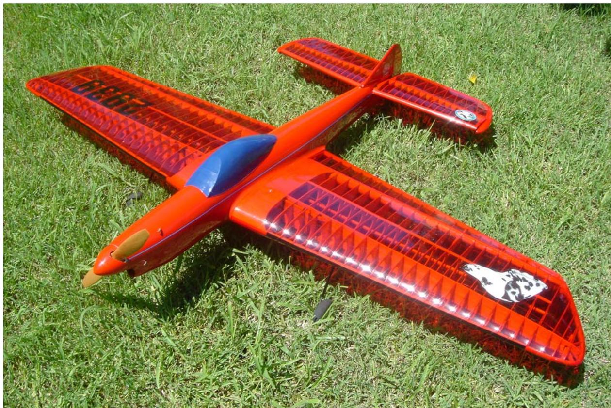
Tutto da ammirare l'ultimo modello di Ennio Marra di Reggio Calabria, il Benny 3. Grazie alla copertura trasparente dell'ala e dei piani di coda è possibile ammirare la bellissima struttura, molto leggera, tipica dello "stile Marra". Il motore è l'ottimo Stalker .61, l'elica una 13x6.
