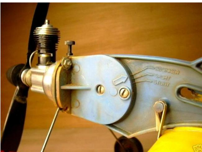
**Il TD-4. Sotto, il particolare del meccanismo per regolare l'incidenza motore**
