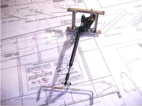
**Il pezzo centrale – da montare in fusoliera – del meccanismo di fissaggio delle semiali, con squadretta e barra di rinvio ai flaps**
