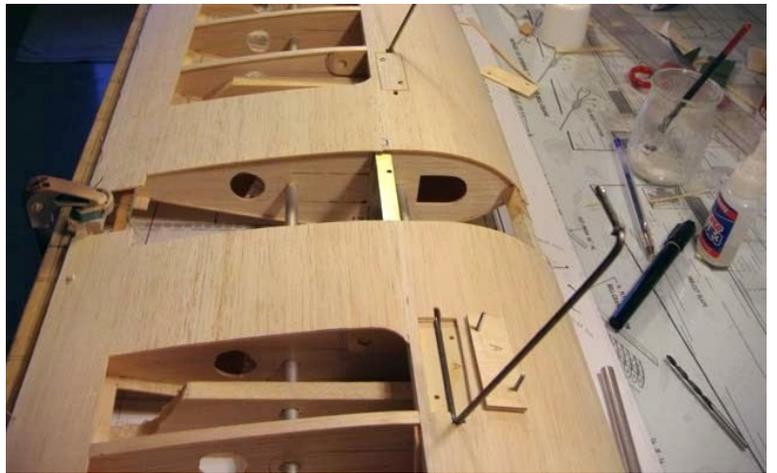
**L'ala è ormai completata e pronta per la finitura, con il relativo sistema di montaggio del carrello.**
