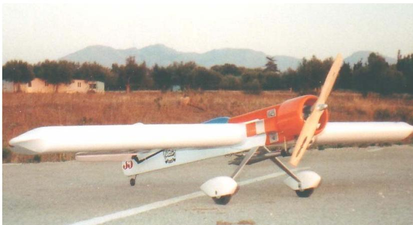
**Fig.8 - Lo *STONE* nel suo ultimo stadio di evoluzione e motorizzato con ST60, elica 13/5. Si nota lo speciale scarico posteriore in alluminio che passa tra le gambe del carrello sotto la fusoliera.**
