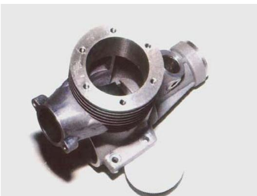
Il carter visto dall'alto: si intravede una delle due luci laterali citate nel testo.
