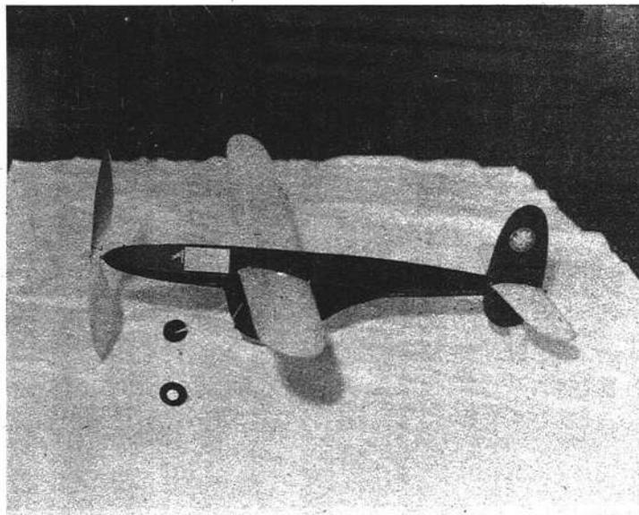
pensato che viene infilata orizzontalmente nell'apposito alloggiamento, quindi raddrizzata ed incastrata al suo posto. Il sistema è molto semplice e leggero; elimina il difetto principale delle fusoliere a diamante, cioè l'impossibilità di variare la posizione e la incidenza dell'ala, soprattutto se questa è media, come nel nostro caso.
