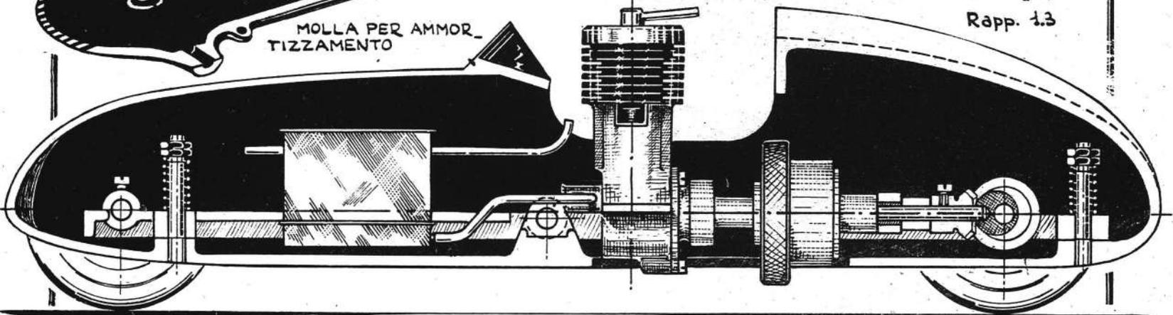
SERBATOIO ANTICENTRIFUGO ALIMENTAZIONE PER CADUTA CON PRESA DINAMICA
