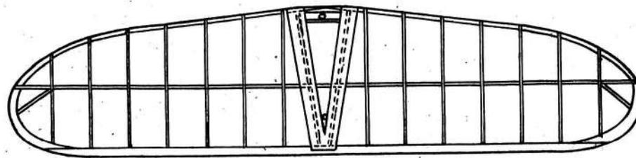
IL LONGHERONE DEL PIANO ORIZZONTALE E' IN BALSA DURO 1.5x6. IL BORDO D'USCITA E' TRIANGOLARE DELLA STESSA SEZIONE
