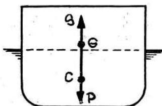
Per un modello navigante la spinta è data dal volume della parte immersa, che dicesi «volume di carena» per il p. s. dell'acqua in cui galleggia. Tale prodotto non è altro che il peso del modello, e si dice «dislocamento», per cui si ha che la spinta è uguale al dislocamento:
