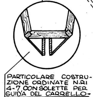
PARTICOLARE COSTRUZIONE ORDINATE N.4-7 CONSOLETTI PER GUIDA DEL CARRELLO
