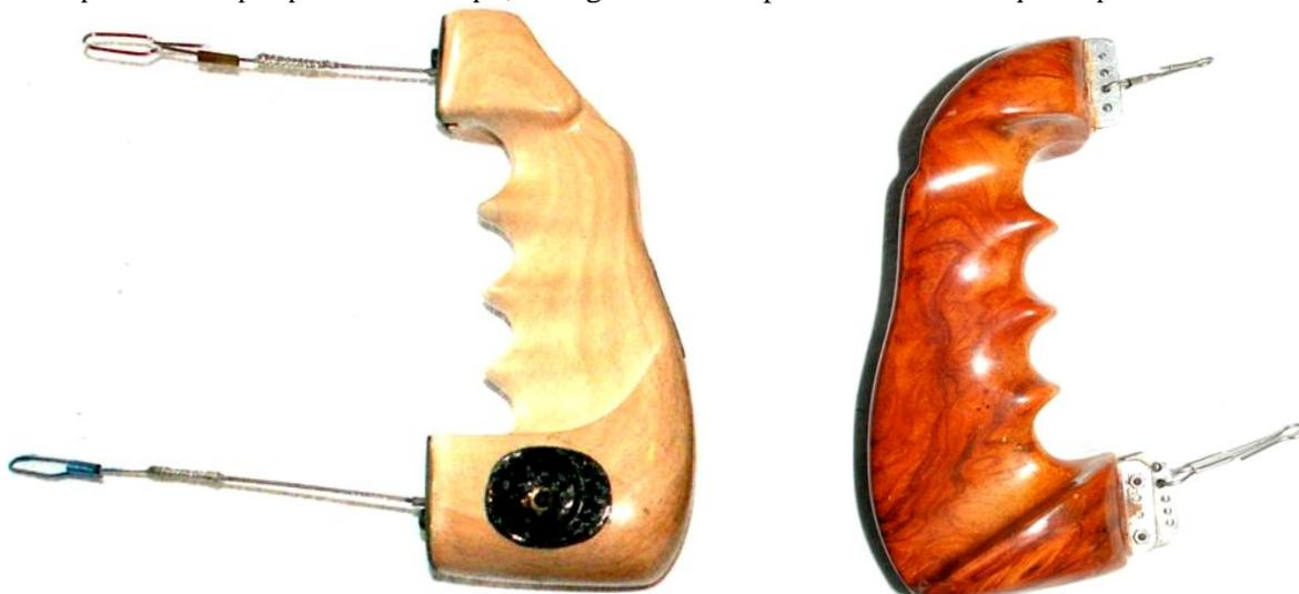
La prima manopola in poliuretano ottenuta da stampo. La regolazione dello zero si ottiene con lo scorrimento del cavo. E' quella che uso attualmente con l'Extra 230.
