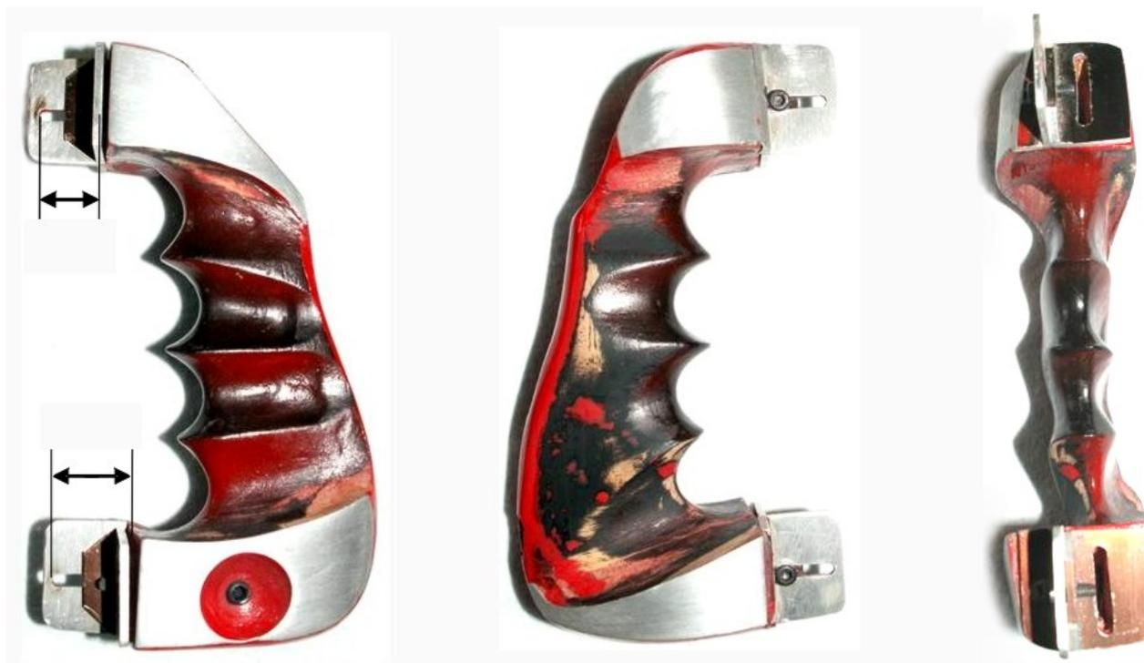
L'ultima non ancora ultimata. E' anche questa in multistrato sagomata a mano. E' predisposta per la regolazione a cavo scorrevole. E' possibile variare, oltre alla regolazione dello zero e dell'altezza, anche la lunghezza delle leve del cabra e del picchia, ma devo ancora provarla.
