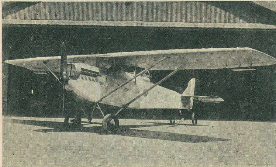
L'aeroplano "A. 120 Fiat", motore Fiat A 24 - 750 HP
