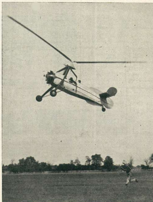
Una dimostrazione pratica della velocità minima dell'autogiro: un uomo può appendere un pacco alla corda calata dall'apparecchio.
