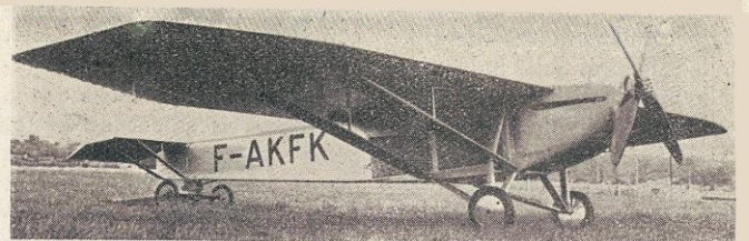
L'apparecchio francese Farman che dovrebbe salire nella stratosfera. Da notare la grande elica a quattro pale per la maggiore presa dell'aria rarefatta.
