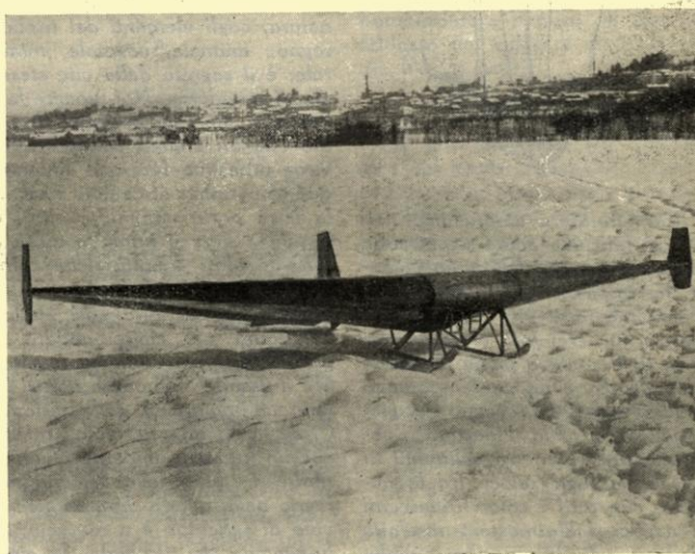
Il "Bertina", un aliante munito di sci per lanci ed atterraggi sulla neve
