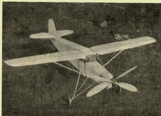
L'aeromodello monoplano « G. V. 15 » con doppia elica coassiale di Giusto Visconti
