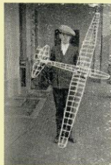
Struttura di un aeroveleggiatore tipo «Balestruccio» costruito in scala da Alberto Boehm dell'Aero Club di Udine.
