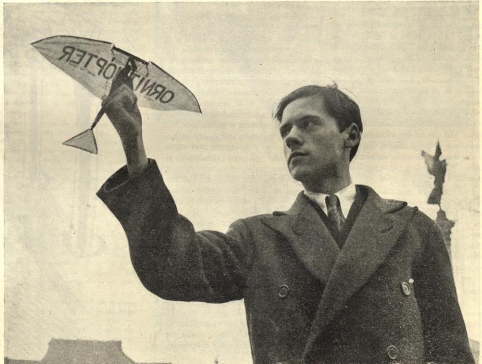
Un ufficiale di marina giapponese ha inventato questo modello di ornittottero che vola con le ali battenti come gli uccelli. Costruito in legno leggerissimo e con le ali in seta, l'apparecchio è azionato da un elastico attorcigliato. Giarella! Al lavoro!
