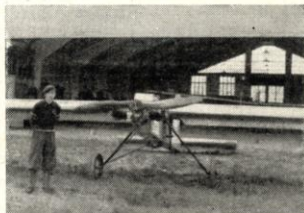
Il buffo motoriale della scuola di volo a vela di Torino. Su questo apparecchio il pilota sta a cavalcioni della fusoliera.
