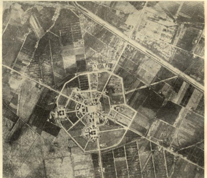
Il confronto tra questa fotografia aerea di Littoria e la cartina dimostra la possibilità di rilevare i minimi particolari che sfuggirebbero al topografo comune.
