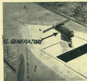
Fig. 2) — Il generatore delle correnti ad alta e bassa tensione collocato sullo scafo di un idrovolante.
