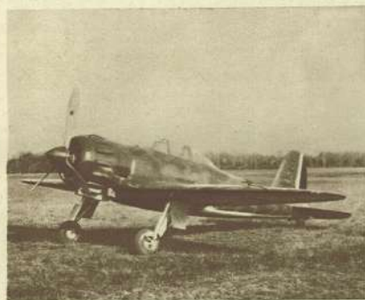
VEICOLO DA CACCIA E INTERCETTAZIONE CAPRONI VIZZOLA "F. 5,, Velocità massima km/h 310; salita a 6000 m. in 6'3"
